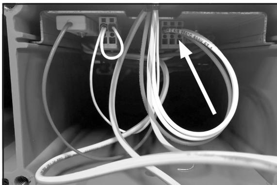
b. 热熔断器连接器（灰色）：白线
