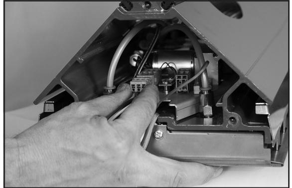
b. 热熔断器连接器（灰色）：白线
