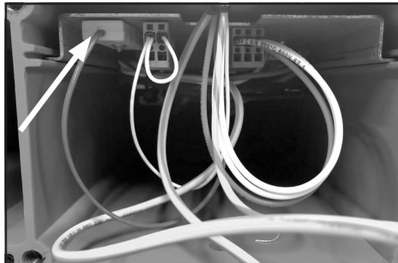
4. 将地线重新连接到端盖，确保地线沿横梁轮廓布置。
