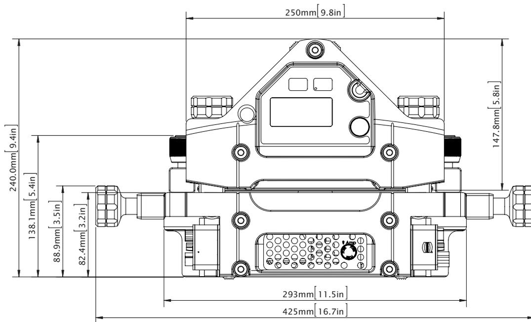
Aero® 325-1225 型号热压机前视图及尺寸。
