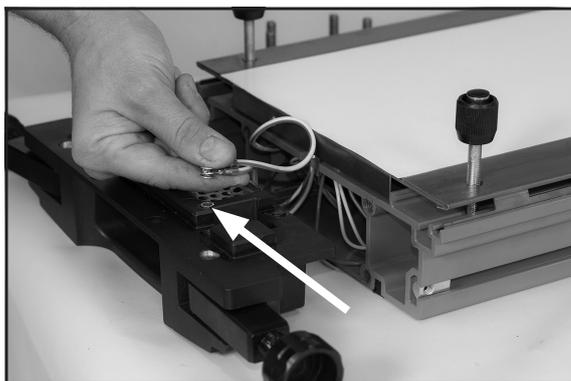
3. 将热压机顶梁中的三个连接器直接拔出以断开连接。
