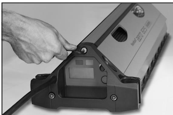
3. 在热压机后侧，重新连接 2 个气动接头。将软管按入快速连接接头。
