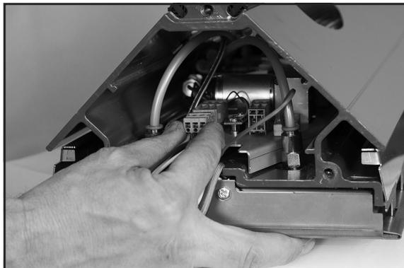
b. 热熔断器连接器（灰色）：白线
