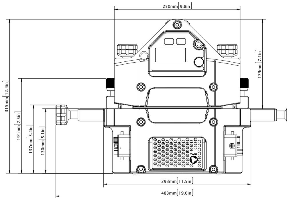
Aero® 1525、1835 和 2135 型号热压机前视图及尺寸。
