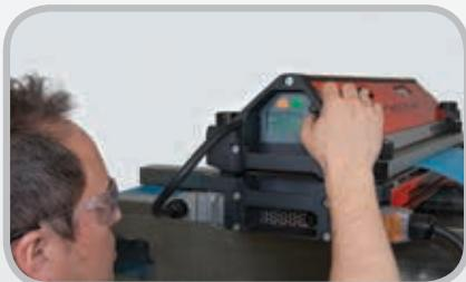
可通过一个 HMI 控制面板非常轻松地对 Aero® 热压机进行设定，并且直观的滚动浏览导航意味着您很快就能制作出自己的第一个高质量接头。
