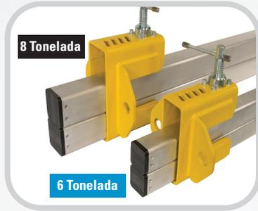
Las mordazas de 6 toneladas están disponibles para bandas hasta de 1800 mm de ancho y hasta de 50 mm de espesor, mientras las mordazas de 8 toneladas están disponibles para bandas hasta de 2400 mm de ancho y hasta de 55 mm de espesor.
