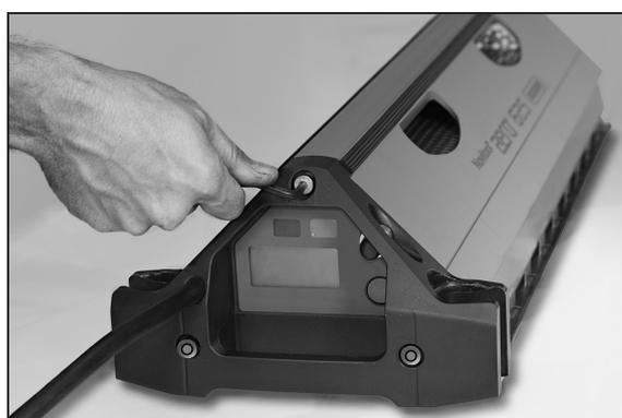
3. プレスの後部で、2つの空気圧接続を再接続します。ホースをクイック接続金具に押し込みます。
