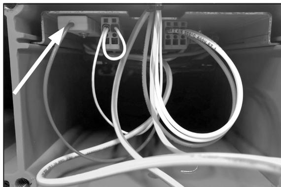
4. アース線をエンドプレートに再接続して、ワイヤーが押し出し側面内に収まるように方向を合わせます。押し出しと同じ高さにヘッドプレートを配置します。ワイヤーをビームとヘッドプレートの上に挟まないように、押し出しの最後のスロットにワイヤーを配置します。抵抗がある場合は、ワイヤーが挟まれている可能性があります。ワイヤーを調整する必要があります。
