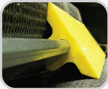
**Diseño de ajuste a presión:** los segmentos de 3" (75mm) están diseñados para liberarse bajo presión si se atoran objetos pequeños entre la banda y los segmentos.
