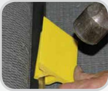
**Fácil de instalar:** Instale el Protector de enganche en su transportador con un mecanismo y soportes sencillos, luego instale los segmentos con un golpe suave de mazo.
