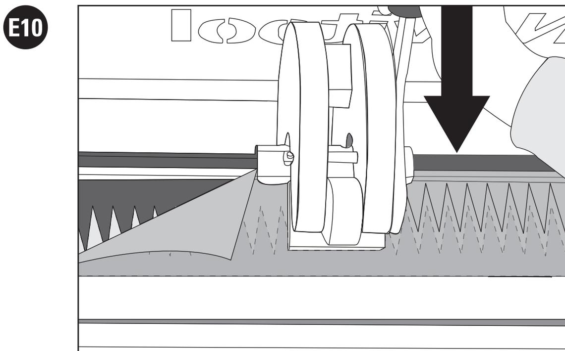
Coloque la cubierta superior y repita el proceso de troquelado para la segunda serie de dedos. Quite el exceso del material perforado.
