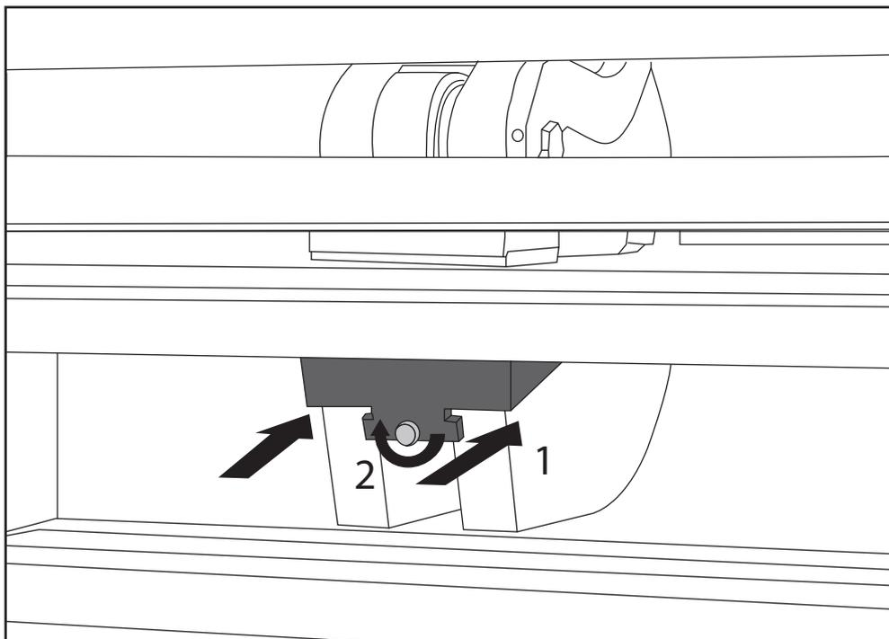
Asegure el troquelador en C. 1. Instale de nuevo la cuña del troquelador en C.
