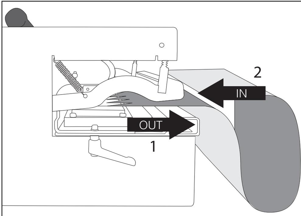
Instale el otro extremo de la banda con el lado de la cubierta hacia abajo sobre la máquina.
