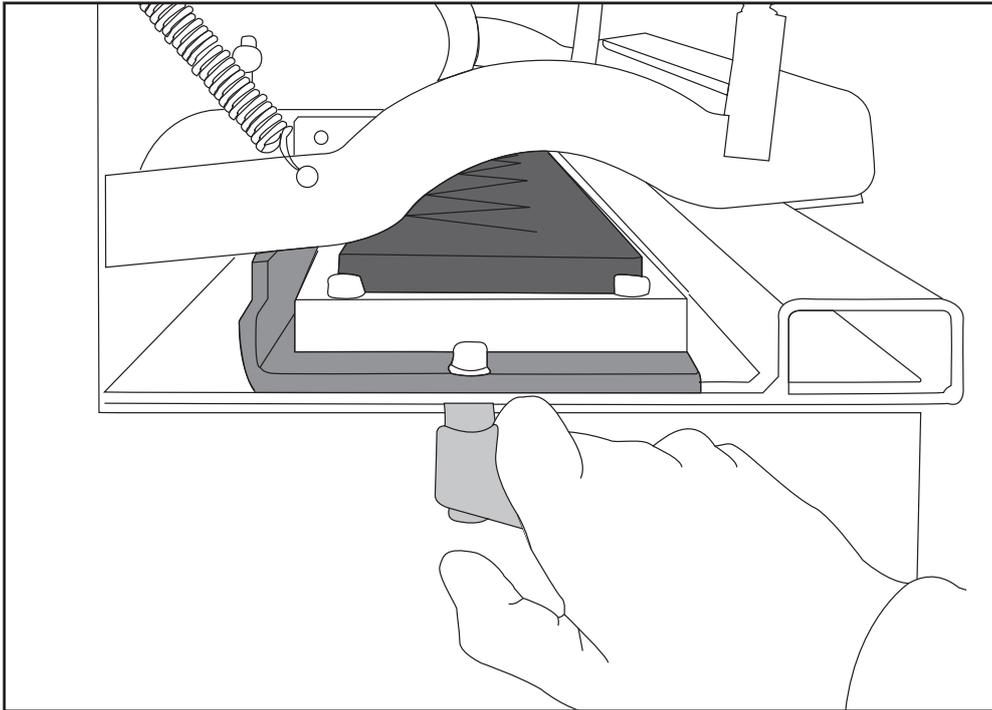
Jale la manija de bloqueo hacia abajo si requiere cambiar la posición para bloquear firmemente la bandeja.
