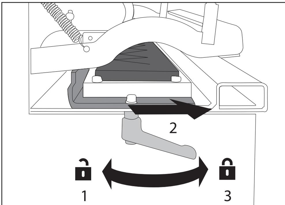
1. Desbloquee la bandeja de la plantilla de troquelado en ambos extremos. 2. Mueva la bandeja de la plantilla de troquelado a la posición delantera. 3. Bloquee la bandeja de la plantilla de troquelado en ambos extremos. **Atención:** Cuando se requiera, vuelva a colocar la manija de bloqueo (B2).
