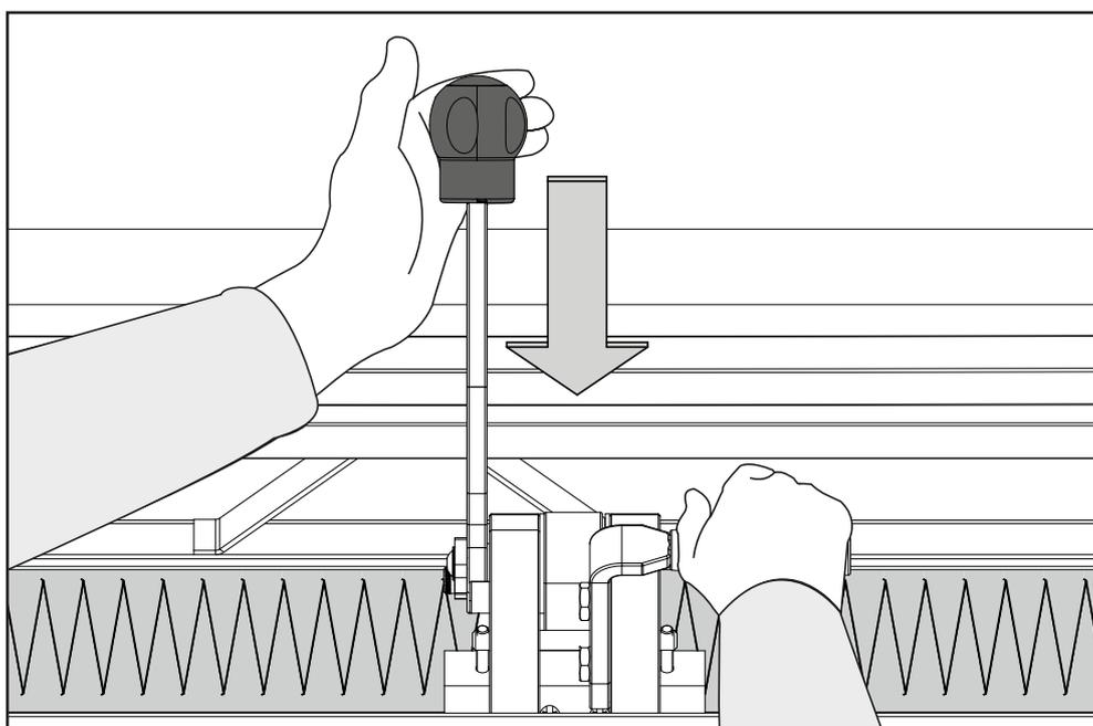
Coloque la mano derecha sobre la manija de tope fija para apoyarse. Utilice la otra mano para operar la palanca que troquelará la banda.
