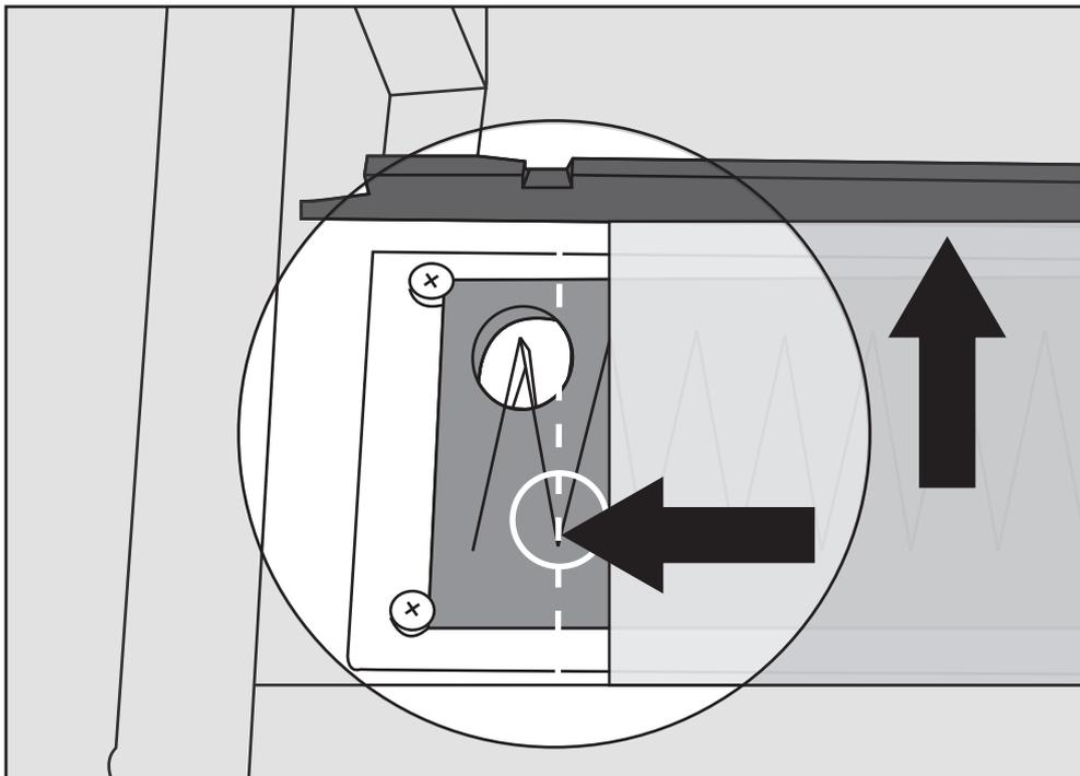
Inserte el extremo de la banda hasta que esté al ras con el tope de la banda.
