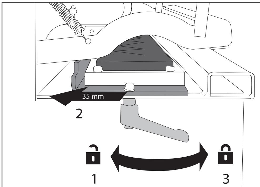
**Mantenga la banda sujeta.** 1. Desbloquee la bandeja de la plantilla de troquelado en ambos extremos. 2. Deslícela a la última posición. 3. Bloquee la bandeja de la plantilla de troquelado en ambos extremos.
