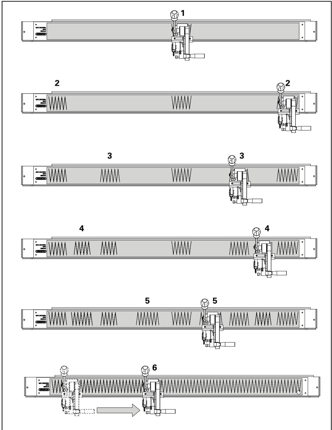
Troquele el centro y ambos extremos. Continúe troquelando los centros de las secciones creadas. Luego troquele el resto del material.
