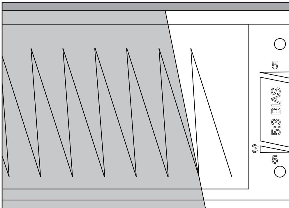
Inserte el lado opuesto de la cubierta del extremo de la banda hacia arriba y al ras contra el tope de la banda. Alinee a la derecha el extremo de la banda con la parte inferior del patrón en v del juego de cuchillas.
