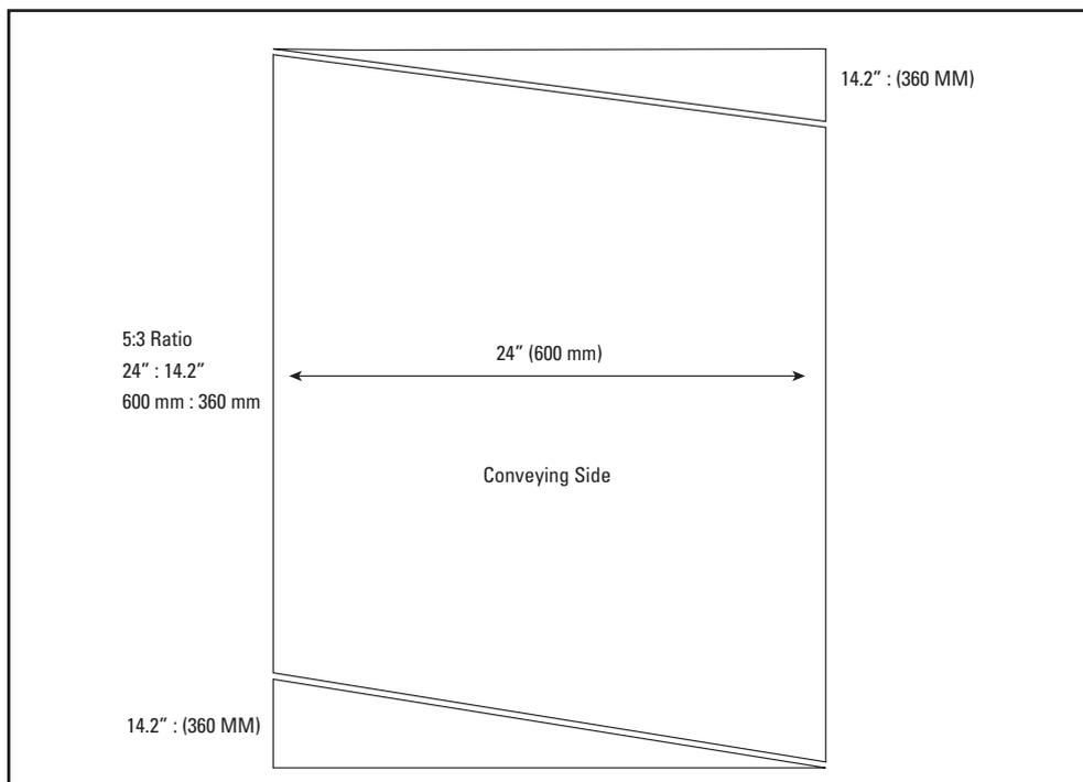
Prepare los extremos de la banda para troquelado dedo sobre dedo desviado al cortar en ángulos opuestos (relación 5:3) en cada extremo de la banda. Utilice Ply 130™ para separar cada extremo de la banda a 110 mm (4.3”) de profundidad.
