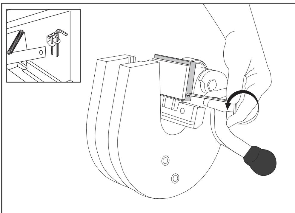
Afloje el tornillo de fijación que sostiene el bloque de troquelado en su lugar cuando requiera cambiarla de posición.
