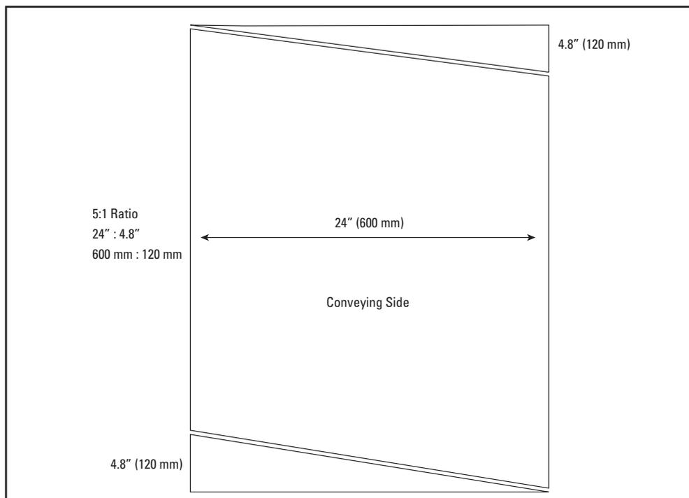
Prepare los extremos de la banda para troquelado de dedo desviado al cortar en ángulos opuestos (relación 5:1) en cada extremo de la banda.
