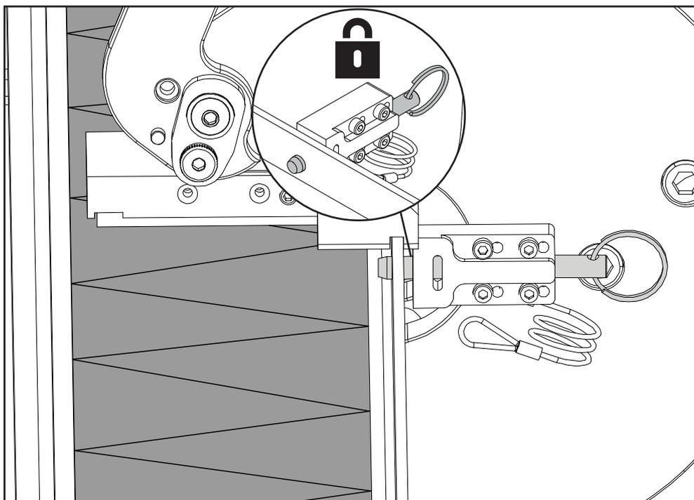
Coloque el troquelador en C en el centro de la bandeja de la plantilla de troquelado y deslice el pasador de bloqueo en el orificio.
