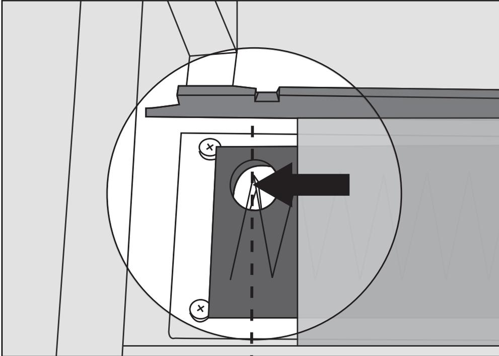
Alinee el material de la banda a la izquierda con la parte superior del patrón en V en el juego de cuchillas.
