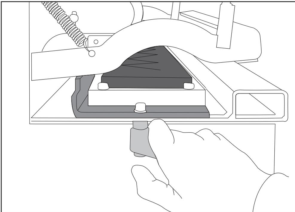
**Mantenga la banda sujeta.** 1. Desbloquee la bandeja de la plantilla de troquelado en ambos extremos. 2. Deslícela a la posición final. 3. Bloquee la bandeja de la plantilla de troquelado en ambos extremos (=35 mm/1.38" de desplazamiento).
