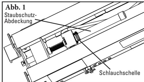
1. Der Flex-Lifter™ muss vor weiteren Schritten in der geschlossenen Stellung sein. Den Flex-Lifter umdrehen. Von der UNTERSEITE des Flex-Lifter aus mit einem Schraubendreher die Schlauchschelle lösen. Den Schlauch der Staubschutzabdeckung und die Schlauchschelle entfernen und entsorgen (Abb. 1).
