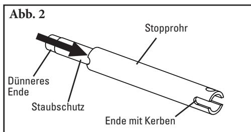
2. Den Staubschutz in den Stoppschlauch schieben. Sicherstellen, dass das dünnere Ende des Staubschutzes vom gekerbten und gebohrten Ende des Stoppschlauchs weg zeigt (Abb. 2).
