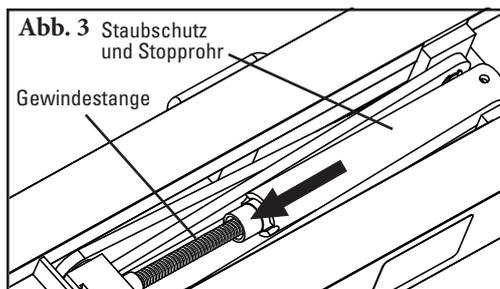
3. Staubschutz und Stopprohr montiert auf die Gewindestange schieben (Abb. 3).
