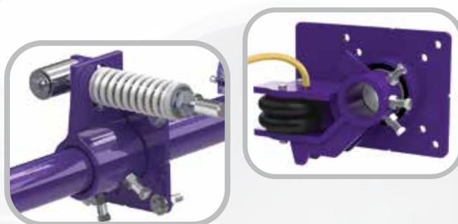
**Resorte de compresión:** Mantener la tensión adecuada es un factor clave para maximizar la duración de la hoja y el rendimiento de limpieza. El sencillo, pero efectivo diseño del resorte de compresión Flexco permite la verificación de tensión en cualquier momento y se puede ajustar sin tener que esperar por el apagado. Flexco también ofrece otros tensores como el de aire y de nitrógeno que pueden ofrecer opciones de rendimiento premium.
