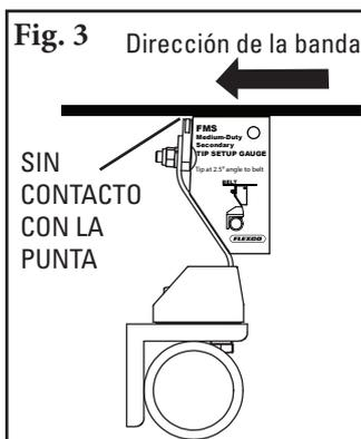
3. **Establezca el ángulo de la hoja.** Centre el eje/hojas en la banda. Gire el eje hasta que las puntas se alineen con el calibrador de ajuste de la punta de FMS que se incluye (Fig. 3). Apriete el tornillo de la mordaza del eje en cada montaje de eje para bloquear el eje en su lugar. Utilice la llave Allen para bloquear el tornillo de fijación. No debe haber contacto de la hoja a la banda mientras bloquea el eje en la posición correcta. Si hay contacto, revise dos veces la medida del Paso 1.
