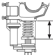
Parte inferior del montaje del eje a la parte inferior de la placa de soporte del resorte
