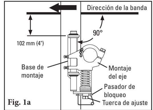
Nota: Para el montaje en el chute, debe trazar una línea de ubicación de la banda en la pared del chute de manera que la base de montaje se pueda alinear 102 mm (4") debajo de la banda (Fig. 1b). Corte orificios de acceso según sea necesario.
