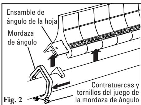
2. **Elimine el ángulo de la hoja del eje.** Afloje las contratuercas de la mordaza de ángulo y los tornillos en ambos lados del limpiador (Fig. 2). Deslice las mordazas de ángulo de cada extremo de ángulo y retire el ensamblaje de ángulo de la hoja del eje.
