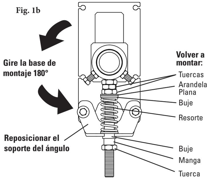
1. **Reconfigure el tensionador estándar modo "elevación" al modo "empuje hacia arriba".** Quite las 3 tuercas, rondana plana, 2 bujes, resorte y casquillo (fig.1a). Gire la base de montaje de modo que las dos bridas apunten hacia abajo y repositone el soporte angular como se muestra en Fig. 1b. Reensamble los componentes en la varilla roscada en el orden que se muestra (Fig. 1b).
