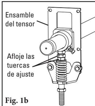
1. **Baje el limpiador fuera de la banda.** Afloje las contratuercas de tensión en las barras roscadas para eliminar la tensión y bajar el limpiador (Fig. 1a - Tensión de elevación; Fig. 1b - Tensión de empuje). Si está instalado en un chute, retire el ensamblaje del tensor del lado cercano para acceder al cartucho de la hoja.
