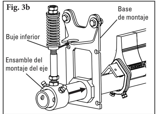
4. **Asegure el eje.** Centro el eje/hojas en la banda y gire el eje hasta que las hojas estén perpendiculares a la banda. Apriete los dos tornillos y tuercas de sujeción en cada ensamble de tensor para bloquear el eje en su lugar (Fig. 4).
