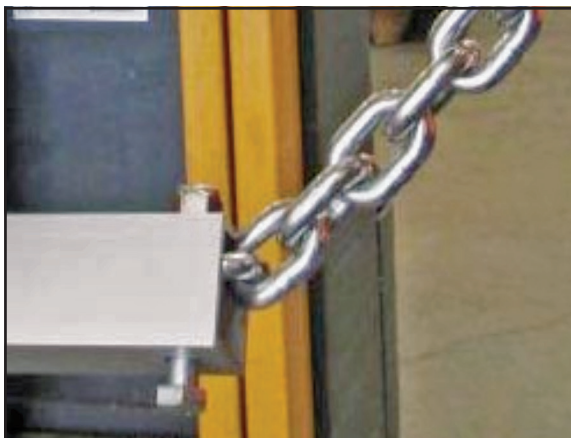
Bild 32 Lange Ketten anbringen
