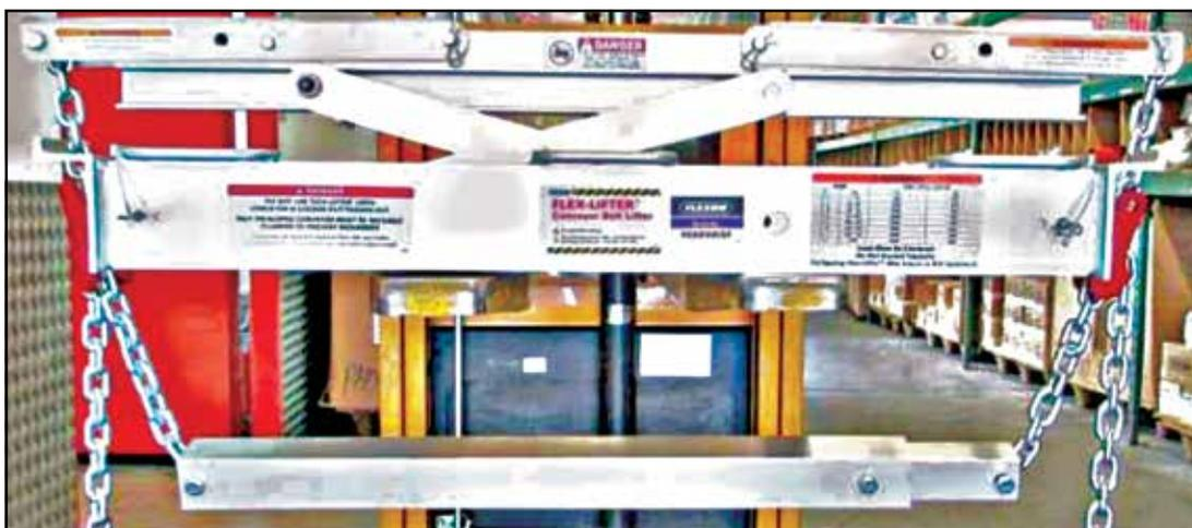
**Bild35** Hebestange an den Ketten hängend
