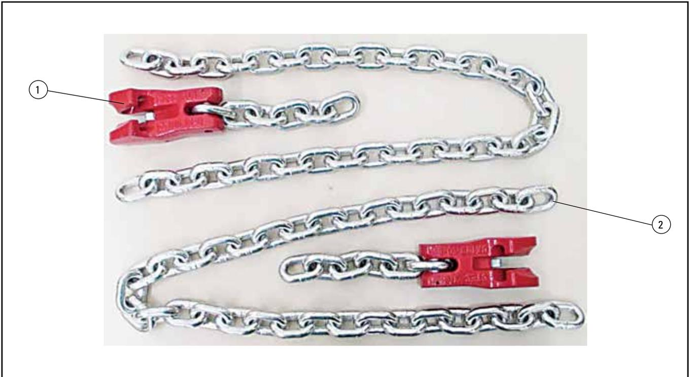
**Bild 10** Ketten der Hebestangen für Untertrumgurte, Beispiel
