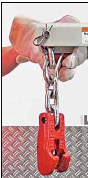
**Bild 31** Kurze Ketten anbringen
