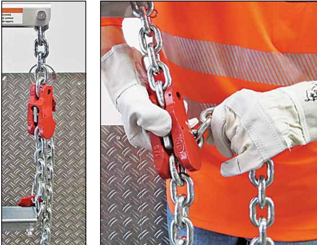
**Bild 34** Ketten der Hebestange aushängen
