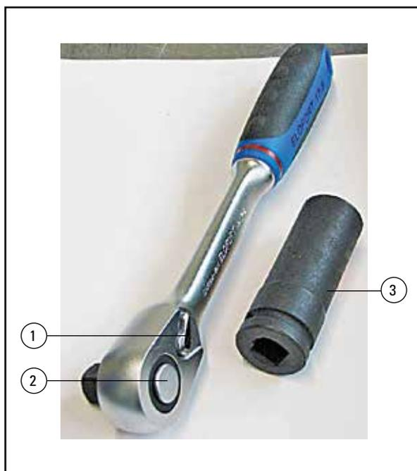
**Bild 13** Steckschlüssel mit Knarre, Beispiel
