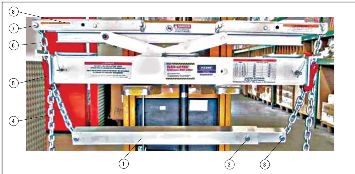
**Bild 6** Flex-Lifter mit Hebestange für Untertrummurt
