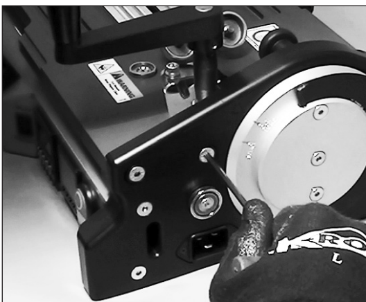
20. Apriete por completo los dos (2) tornillos de bloqueo de la placa lateral adyacente.
