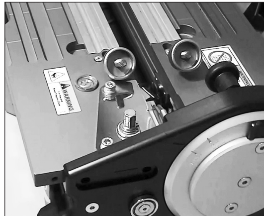
2. Deslice otra vez la placa fija por las ranuras de retención de la placa delantera.
