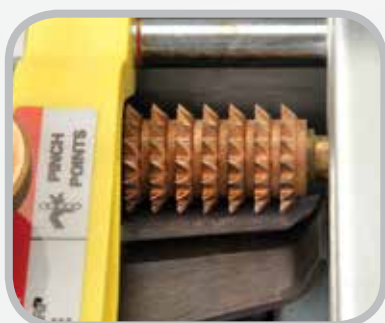
前端驱动托辊在去皮的开始处紧紧地抓住输送带以阻止其滑动。
