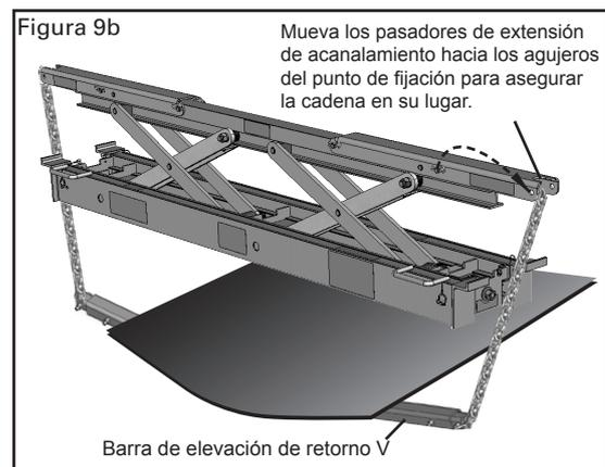
**PASO 10. Levante la banda.** Gire la tuerca de ajuste hacia la izquierda hasta que la banda esté a la altura deseada. (Utilice el dado de 24mm (15/16") y la herramienta, no se incluyan). Retire el ratchet o la herramienta eléctrica antes de empezar a trabajar.
