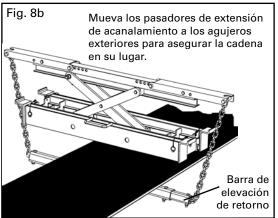
PASO 10. Levante la banda. Gire la tuerca de ajuste hacia la izquierda hasta que la banda esté a la altura deseada. (Utilice la herramienta y eldado de tamaño correcto, no se incluyen). Retire el ratchet o la herramienta eléctrica antes de empezar a trabajar.
