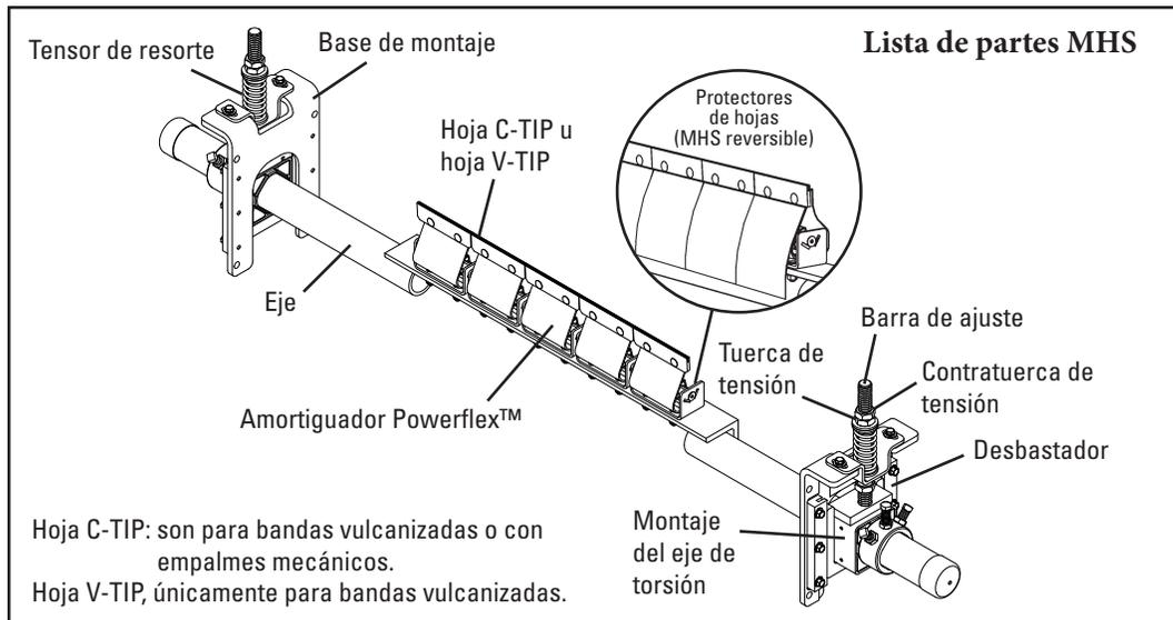
**Etiquete y bloquee físicamente el transportador en la fuente de energía antes de empezar la instalación del limpiador.**
