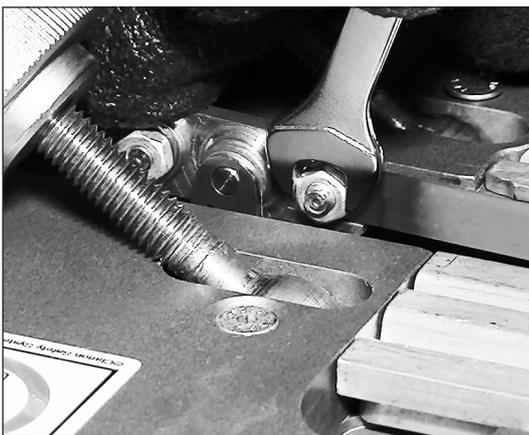
8. DIE FEDER NICHT LOSLASSEN. Das vorzeitige Lösen des Federdrucks kann zu Schäden an der Emitter-Befestigungsbohrung führen. Sicherstellen, dass der Emitter in der Aussparung im Emitter-Block sitzt. Die Tellerfeder so auf den Stehbolzen setzen, dass die Seite mit der großen Kontaktfläche am Emitter-Streifen sitzt. Die Halterungsmutter eindrehen und so festziehen, dass die Tellerfeder vollständig zusammengedrückt ist. Die Tellerfeder kann jetzt losgelassen werden.
