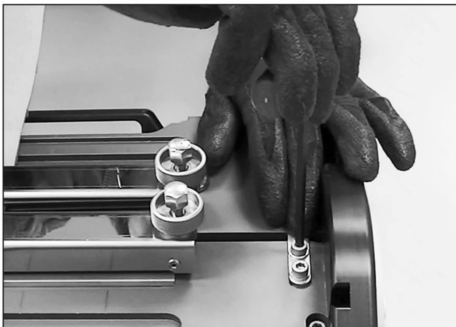
Die beiden Innensechskantschrauben mit einem 5 mm Inbusschlüssel festziehen. Diesen Vorgang an der Heizplatten-Anschlagplatte am gegenüberliegenden Ende der Platten wiederholen.
