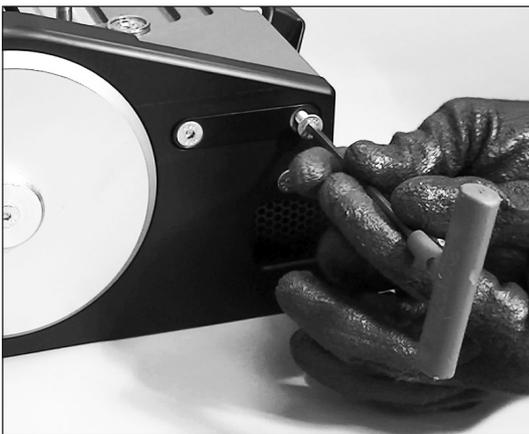
1. Vier (4) Heizplattenschrauben lösen und entfernen.
