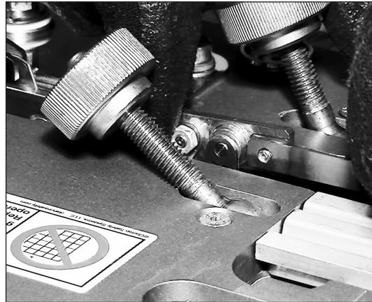
7. Den Emitter-Federspanner zusammendrücken, damit die Emitter-Befestigungsbohrung auf die Stehbolzen des Kupfer-Emitterblocks gesetzt werden kann.
