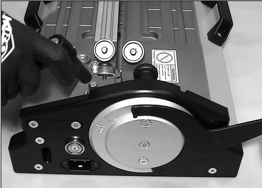
Die Bandschneider-Kurbel an der Bandschneider-Antriebswelle befestigen.
