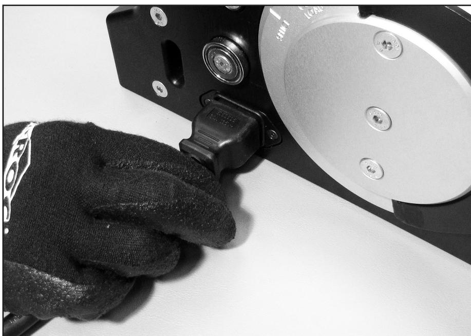
Das richtige Stromversorgungskabel auswählen und in den Netzkabel-Eingang der Maschine stecken.
