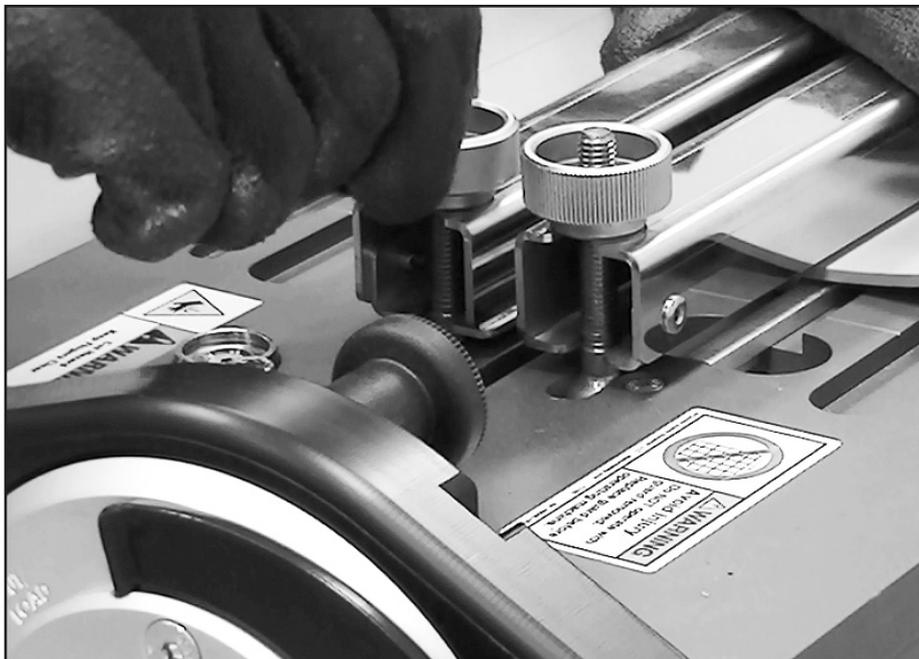
Die Transportband-Klemmbalken einsetzen und festziehen. Dabei darauf achten, dass die Antriebsstege-Balken sicher in den Schablonen sitzen.
