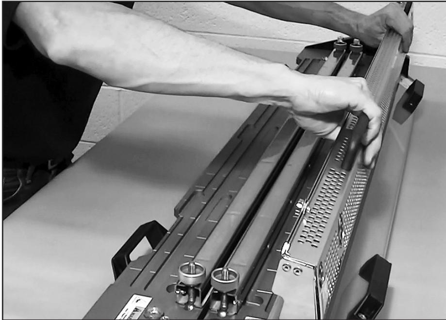
Die Schutzvorrichtung von der Maschine entfernen.
