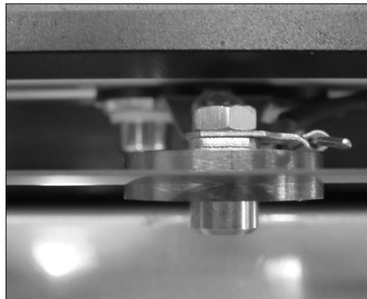
9. Sicherstellen, dass der Emitter auf (oder über) der Emitter-Stützrolle sitzt. **Hinweis!** Der Emitter kann leicht gebogen sein, was den sofortigen Kontakt mit der Stützrolle verhindern könnte. Dies ändert sich nach mehreren Konditionierungs-Heizzyklen. Sicherstellen, dass der Emitter nicht das Thermoelement berührt.
