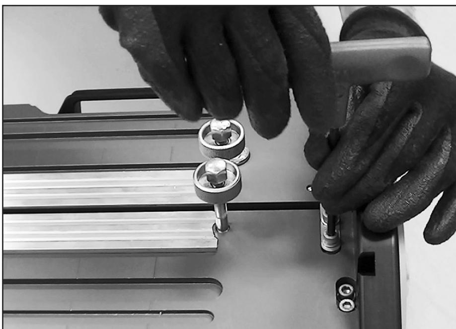
An der Heizplatten-Anschlagplatte die beiden Innensechskantschrauben mit einem 5 mm Inbusschlüssel lösen. Diesen Vorgang an der Heizplatten-Anschlagplatte am gegenüberliegenden Ende der Platten wiederholen.
