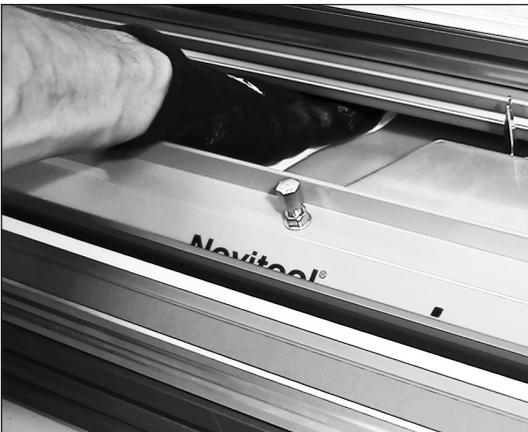
7. Um für die Reinigung der gegenüberliegenden Seite unter die verschiebbare Platte zu gelangen, den Emitter anheben. Nach der Reinigung den Emitter wieder absenken.
