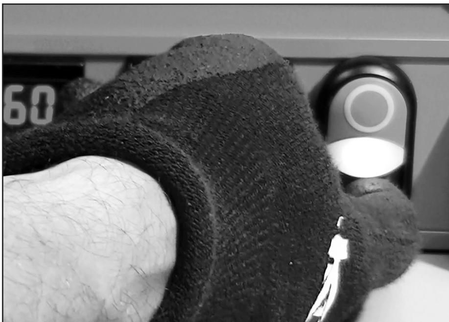
Wenn sich die Maschine auf die "Splice"-Temperatur abgekühlt hat und das Licht aufleuchtet, die grüne Start-Taste sofort drücken, um den Heizzyklus für das Verbinden zu starten. Die Maschine während des Verbindungszyklus nicht aus den Augen lassen.
