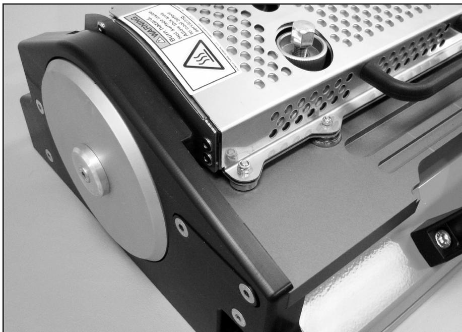
Die Schutzvorrichtung montieren und darauf achten, dass die magnetischen Halterungen sicher und fest sitzen.
