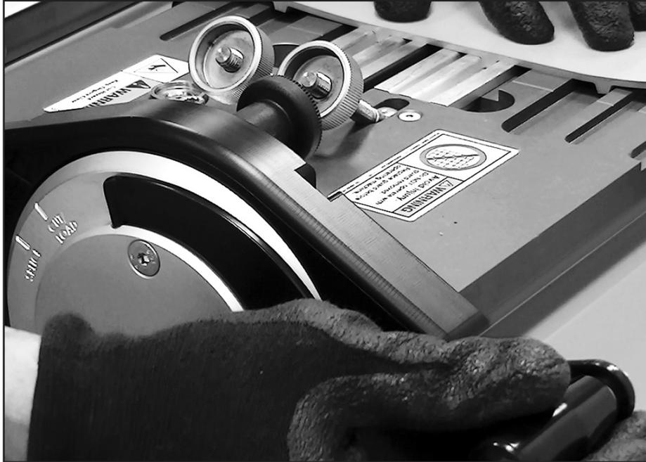
Das Transportband so einsetzen, dass der Antriebssteg-Balken in beide Schablonen eingreift. Den Betätigungshebel zwischen die Stellungen "Cut/Load" (Schneiden/Laden) und "Splice" (Verbinden) drehen.
