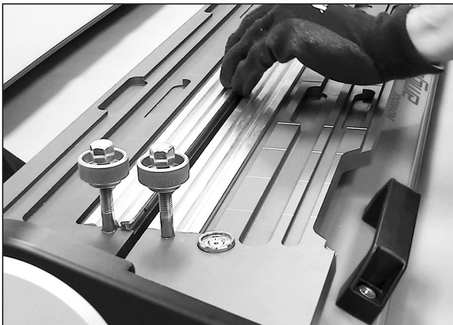
Sicherstellen, dass die Schablonen- und Heizplatten-Aufnahmeslitze sauber und frei von Rückständen sind. Die Schablonen sind richtungsgebunden und so geformt, dass sie in der richtigen Richtung passen. Für den sicheren Sitz zuerst die Außenkante einführen und dann die Innenkante nach unten drücken.
