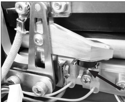
1. Zum Zurücksetzen die rote Taste mit einem 3-mm-Inbusschlüssel nach oben ziehen.
