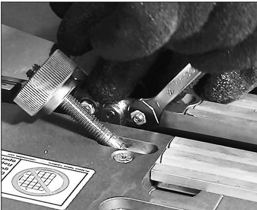
1. Mit einem 7 mm-Gabelschlüssel, zuerst die Emitter-Halterungsmutter auf der Federspanner-Seite der Maschine entfernen. Eine Tellerfeder befindet sich zwischen Halterungsmutter und Emitter. Vorsichtig vorgehen, damit die Mutter oder der Federteller nicht in die Maschine fällt. Falls Teile in die Maschine fallen, siehe "REINIGEN DER MASCHINE".
