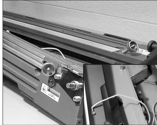
4. Die Reglerseite der Heizplatte aus der Haltenut der vorderen Platte herausdrehen. Die Heizplatte nahe der Maschine ablegen. **Vorsicht!** An der Heizplatte ist eine Erdungsleitung angebracht. Vorsichtig vorgehen, um eine Beschädigung dieses Kabels und dessen Verbindung zu vermeiden.
