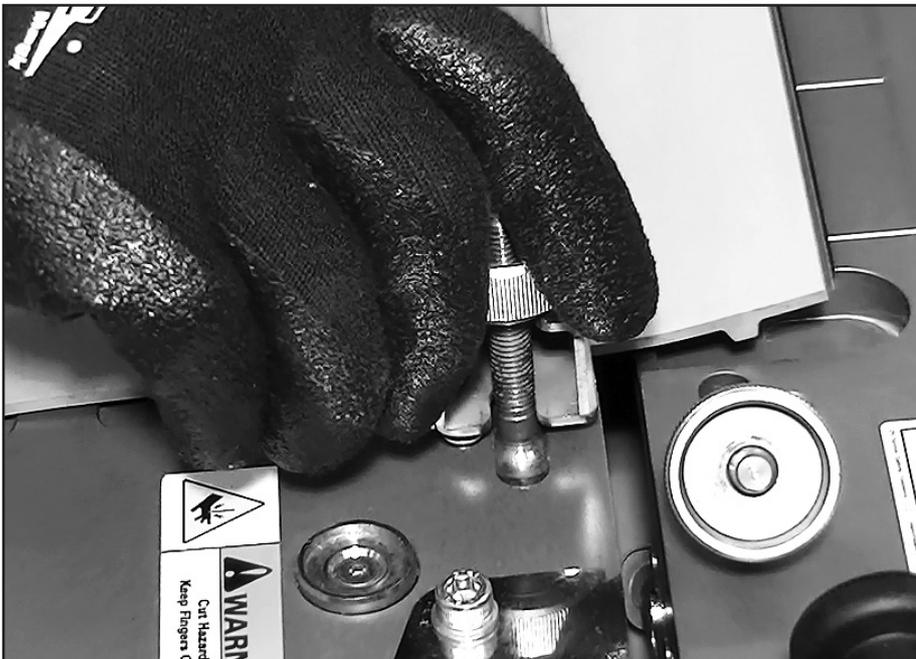
Einen Klemmbalken fest über eingesetztem Band und Schablone installieren.
