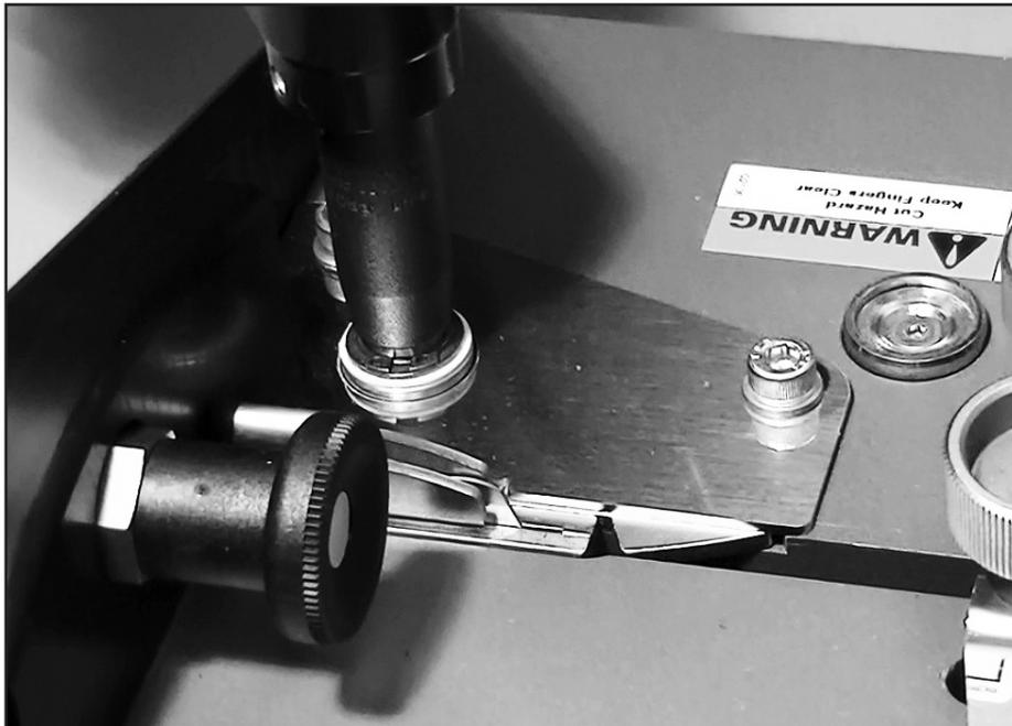
Die Kurbel weiter drehen, bis das Schneidmesser in der Endstellung ist und die Verriegelung aktiviert wird.
