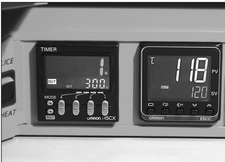
Die Vorwärmzeit abwarten. Ein akustisches Signal ertönt am Ende des Vorwärmzyklus. Die Maschine und das Transportband bis auf die voreingestellte "splice start"-Temperatur abkühlen lassen.
