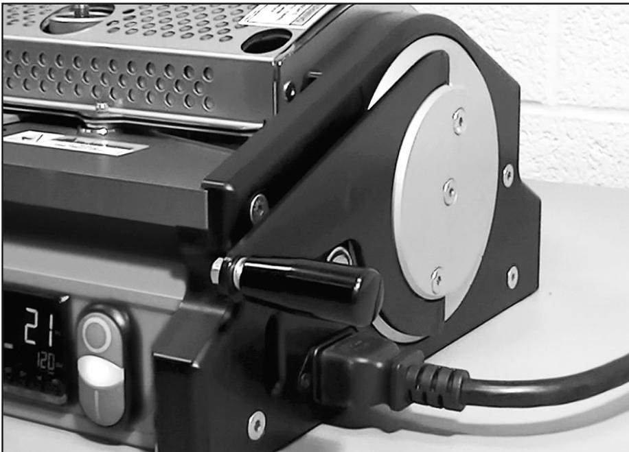
Die Heizplatten öffnen und den Emitter mit dem Betätigungshebel in die Heizstellung heben.
