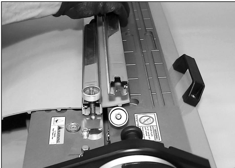
Den anderen Klemmbalken nur lose installieren. DEN KLEMMBALKEN NICHT FESTZIEHEN. Dieser Klemmbalken wird zum Schutz vor dem Schneidblatt installiert. Es ist wichtig, dass das Transportband auf der leicht geklemmten Seite des Schneidblatts beim Schneidvorgang beweglich ist.
