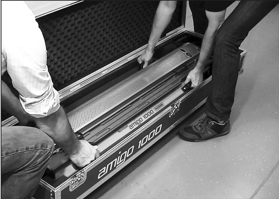
Transportbox öffnen und die Maschine heraus heben. **Vorsicht!** Zwei Personen sind erforderlich, um die Maschine anzuheben und zu positionieren. Die Maschine mit den Heizplatten nach oben auf eine ebene Oberfläche stellen und nivellieren. Die Stromversorgung NICHT anschließen, bis das Transportband in Vorbereitung für das Verbinden geschnitten und eingespannt ist. Sicherstellen, dass der Netz-Eingang, die Regler und die Bandschneider-Kurbel zugänglich sind.
