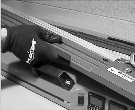
3. Die Seite der Heizplatte anheben, die sich gegenüber der Reglerseite befindet.
