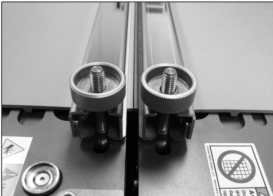
Den Betätigungshebel so drehen, dass die beiden vorbereiteten Bandenden aneinanderstoßen. Der Spalt sollte entlang der gesamten Stoßlinie nicht größer als ca. 0,1 mm sein. Wenn der Spalt größer oder nicht gleichmäßig breit ist, kann es notwendig sein, die Bandenden noch einmal vorzubereiten.
