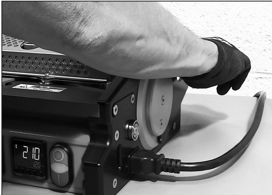
Ein akustisches Signal zeigt an, wenn der Heizzyklus für die Verbindung beendet ist. Den Betätigungshebel sofort (innerhalb 1 Sekunde) nach dem Ton in die Stellung für das Verbinden drehen und ihn ca. 5 Sekunden lang festhalten. Den Betätigungshebel nicht gegen den inneren Anschlag drücken.
