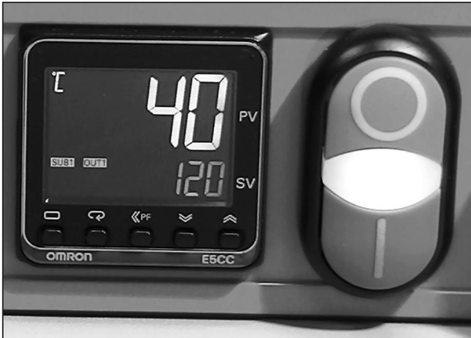
Die werksseitig eingestellte Start-Temperatur des Verbindens ist 40°C. Eine weiße Lampe am Start/Stop-Schalter leuchtet auf, wenn die Steuertemperatur erreicht oder unterschritten wird.
