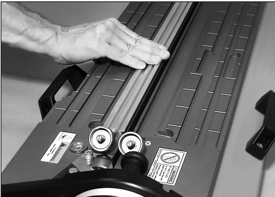
Sicherstellen, dass nur eine Schablone installiert ist.
