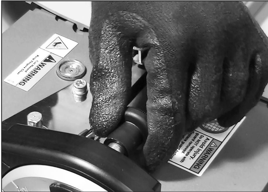
Wenn die beiden vorbereiteten Bandenden in der Maschine geklemmt sind, am Arretierstift ziehen und drehen, um ihn zu lösen. **Hinweis!** Der Pin ist so positioniert, dass er die Bewegungen des Betätigungshebels beim Verbinden nicht behindert.
