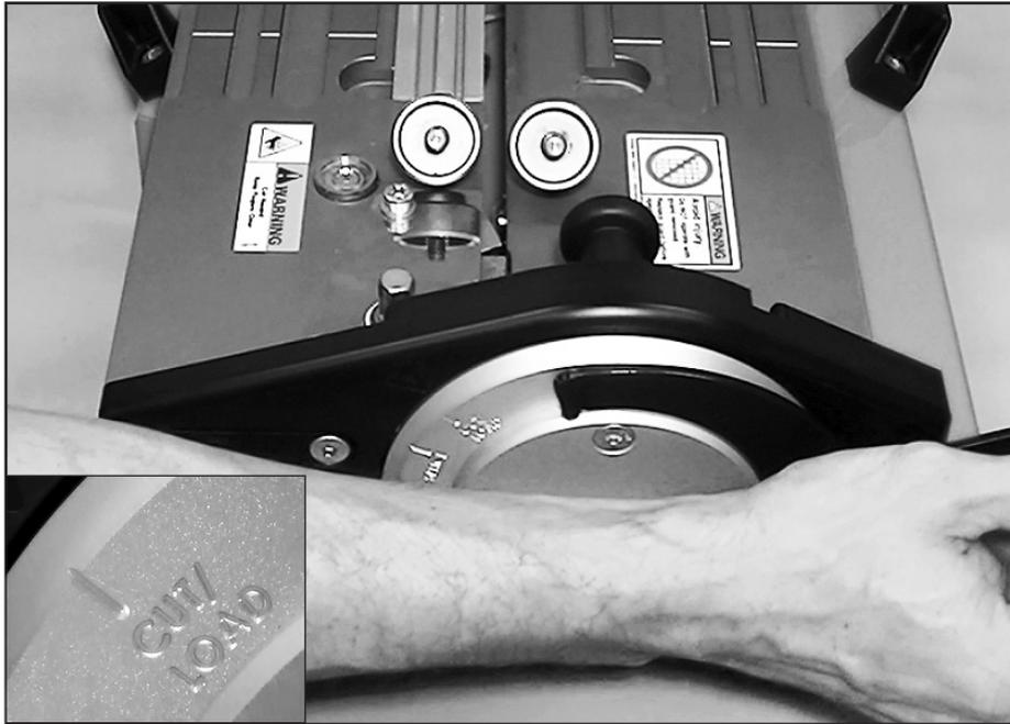
Den Hebel in die Stellung "Cut/Load" (Schneiden/Laden) drehen.
