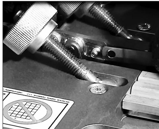
2. Nachdem Emitter-Halterungsmutter und Tellerfeder entfernt wurden, den Emitter-Federspanner und den Emitter vom Emitterblockhalterungs-Stehbolzen lösen.
