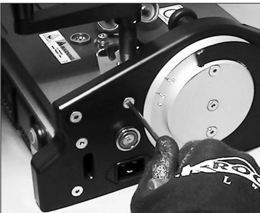
18. Die beiden (2) Heizplattenschrauben an der Reglerseite lösen.
