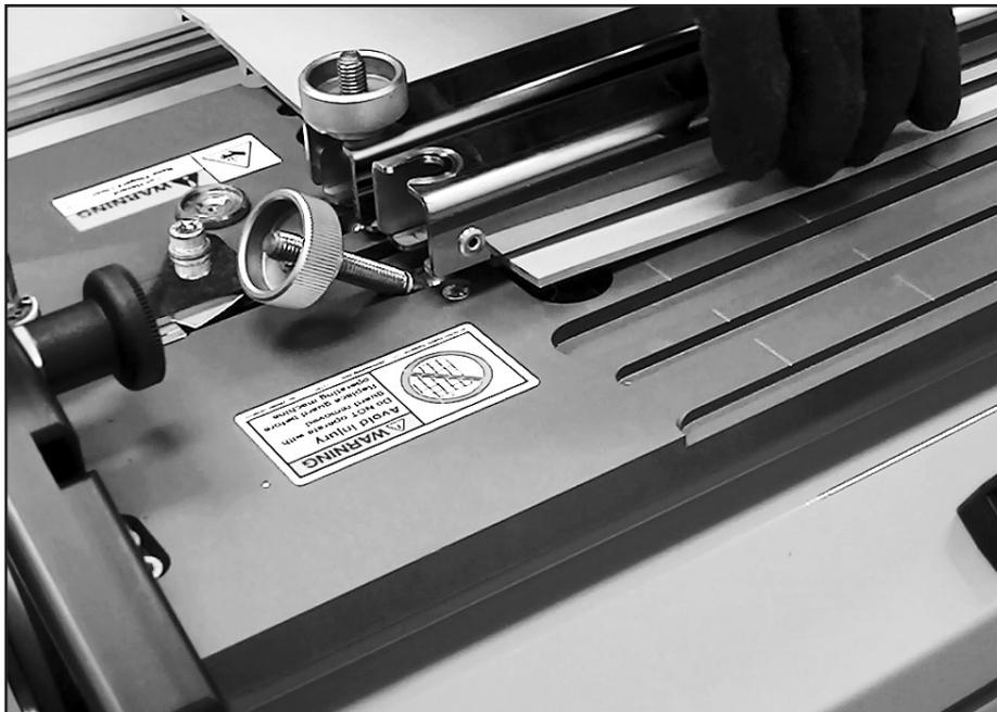
Die Klemm-Rändelmuttern lösen und die Klemmbalken entfernen. Die vorbereiteten Transportband-Enden ganz von der Maschine nehmen.
