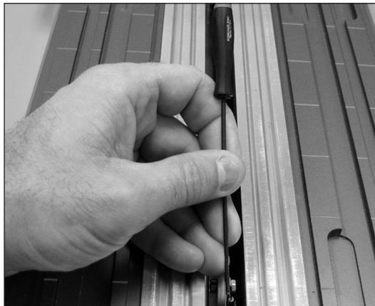
**11.** Die Schutzvorrichtung abnehmen. Mit einem 2 mm-Kugelkopf-Inbusschlüssel den 2 mm-Abstand zwischen Emitter und Thermoelement überprüfen. Dies ist die werkseitige Einstellung und sollte nicht geändert werden, es sei denn das Thermoelement wird beim Austausch des Emitters berührt. Das Thermoelement vorsichtig einstellen, aber nur wenn es erforderlich ist. Zur Justierung der Lage des Thermoelements leicht dagegen drücken. Die Höhe des Thermoelements wird nicht eingestellt.
