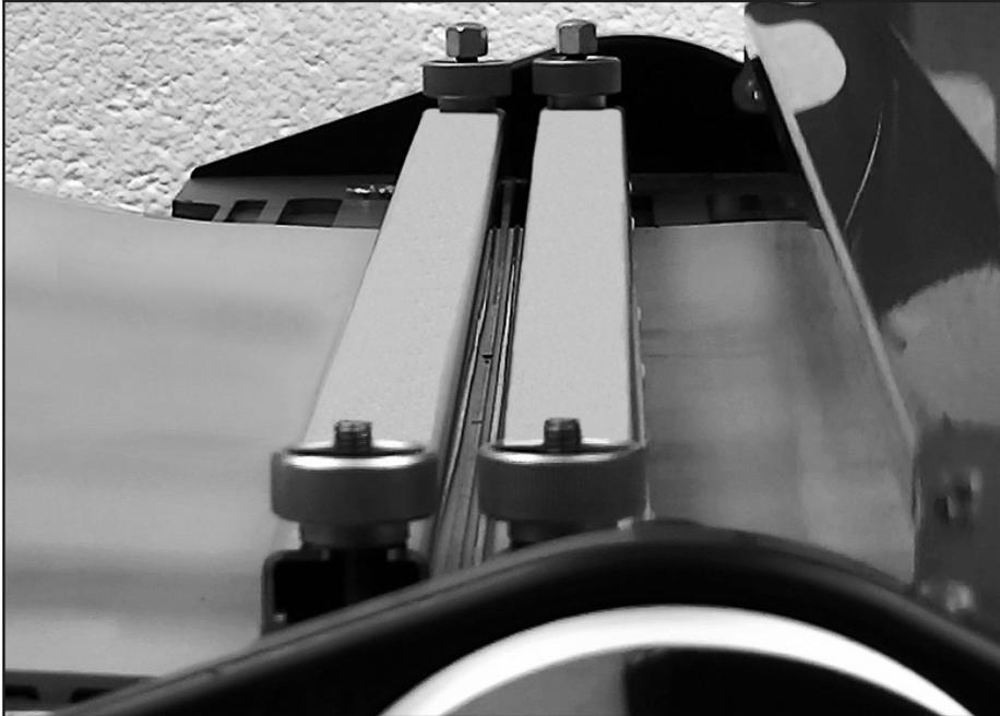
Nachdem das Licht signalisiert, dass der Verbinde-Vorgang abgeschlossen ist, die Schutzvorrichtung entfernen. **Vorsicht!** Schutzvorrichtung, Klemmbalken und Klemm-Rändelmutter sind nach der Anzeige für das Ende des Verbinde-Vorgangs noch heiß.
