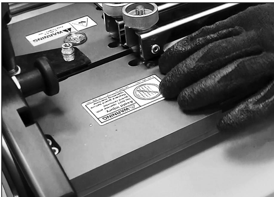
Das Transportband abstützen, um zu vermeiden, dass es sich beim Schneiden bewegt. Wird dies unterlassen, führt das zu einem ungleichmäßigen Schnitt an den Stellen, an denen das Schneidmesser das Transportband verlässt. Die FEST EINGEKLEMMTE Seite des Bandes ist nun bereit für das Verbinden.
