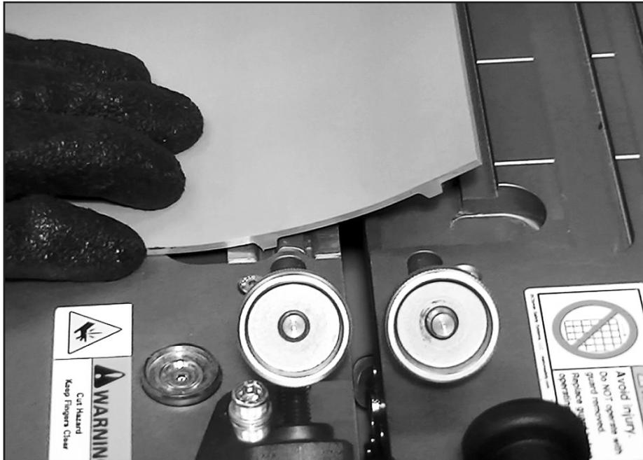
Das Transportband an der Schablone einführen. Positionieren, um einen Problembereich im Transportband herauszuschneiden oder einfach um das Transportband-Ende mit einem präzisen Schnitt auf die Verbindung vorzubereiten. Das Transportband muss den Spalt zwischen den Heizplatten vollständig überdecken. **Hinweis!** Nur Bandenden, die mit dem integrierten Schneidmesser präzise vorbereitet sind, haben eine für das Verbinden ausreichende Genauigkeit.
