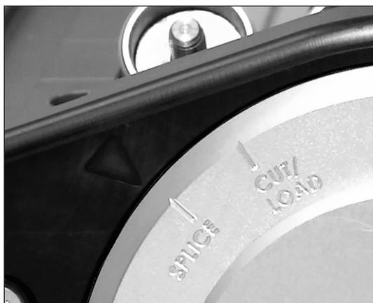
1. Den Betätigungshebel in die Stellung SPLICE (Verbinden) drehen. **Vorsicht!** Während des Betriebs liegt der Emitter frei. Vorsichtig ist geboten, um Schäden zu vermeiden.
