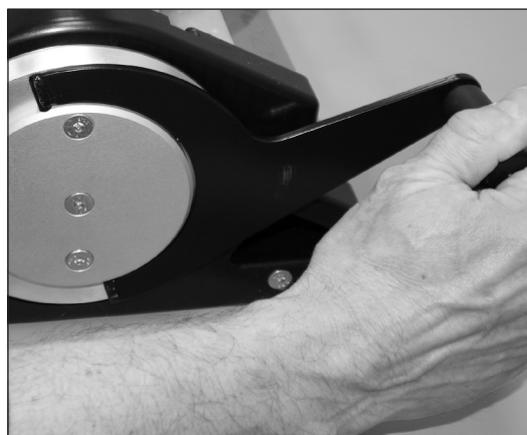
6. Den Betätigungshebel/die Kurvenscheibe drehen, um die Heizplatten zu schließen.
