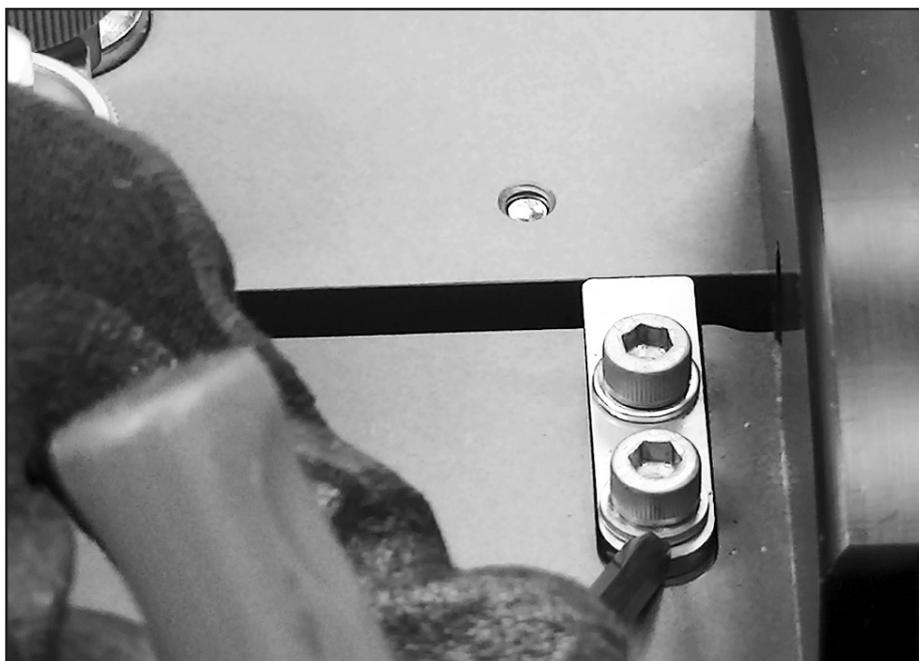
Die Heizplatten-Anschlagplatte bis zum Kontakt mit der festen Heizplatte verschieben. Diesen Vorgang für die Heizplatten-Anschlagplatte am gegenüberliegenden Ende der Platten wiederholen - bis zum Kontakt mit dem Blatthalter verschieben.
