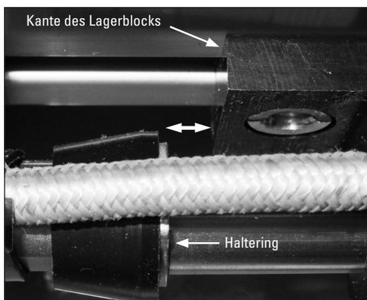
1. Der Ende-der-Emitter-Lebensdauer-Haltering ist mit der Lagerblock-Kante ausgerichtet, wenn der Emitter kalt ist. Die Emitter-Lebensdauer-Anzeige in kaltem und spannungsfreiem Zustand prüfen. Das Bild unten zeigt, dass der Emitter noch eine lange Lebensdauer hat. Der Emitter ist am Ende seiner Lebensdauer, wenn die Länge des Pfeils Null ist. Der Emitter muss ausgetauscht werden, wenn der Haltering mit der Lagerblock-Kante wie abgebildet bündig ist - in kaltem, spannungsfreiem Zustand.
