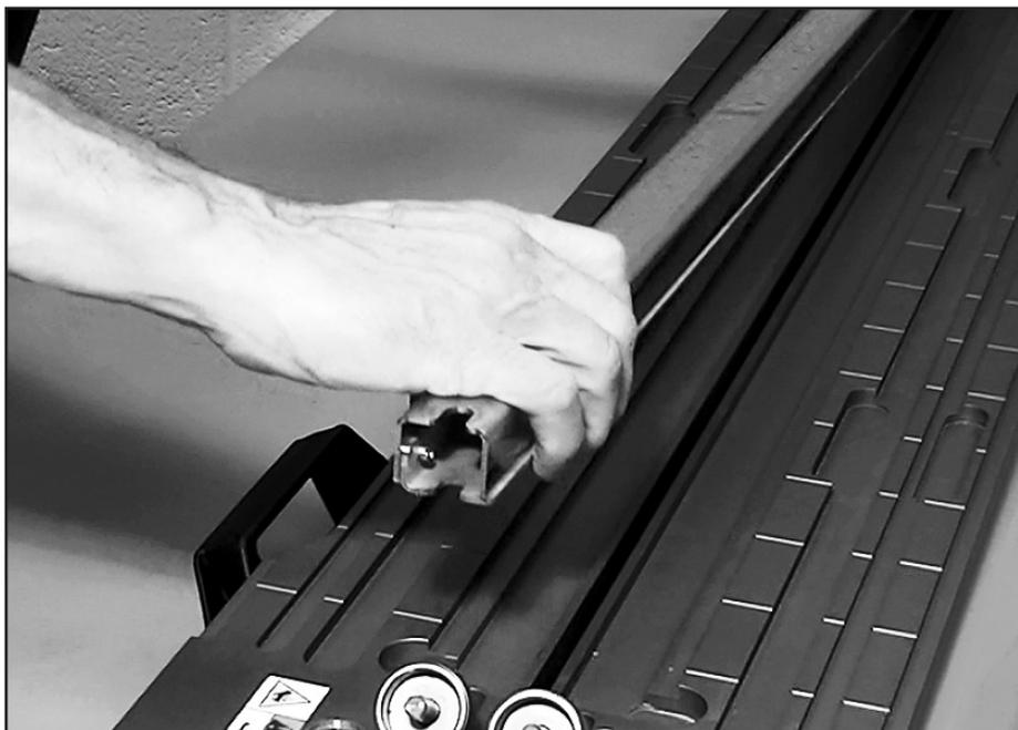
Die Transportband-Klemmbalken von der Maschine entfernen.
