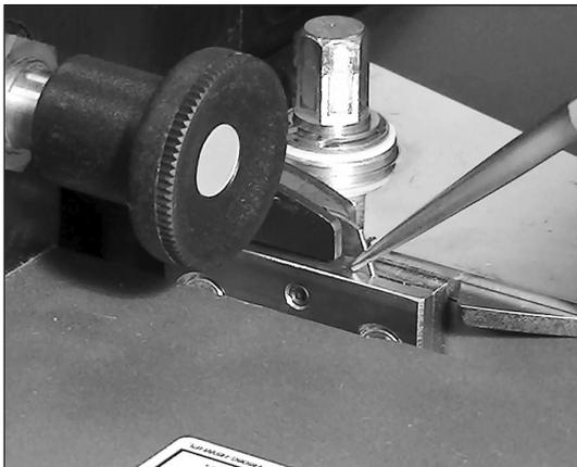
3. Mit einer Zange das Schneidmesser aus der Halterung entfernen.
