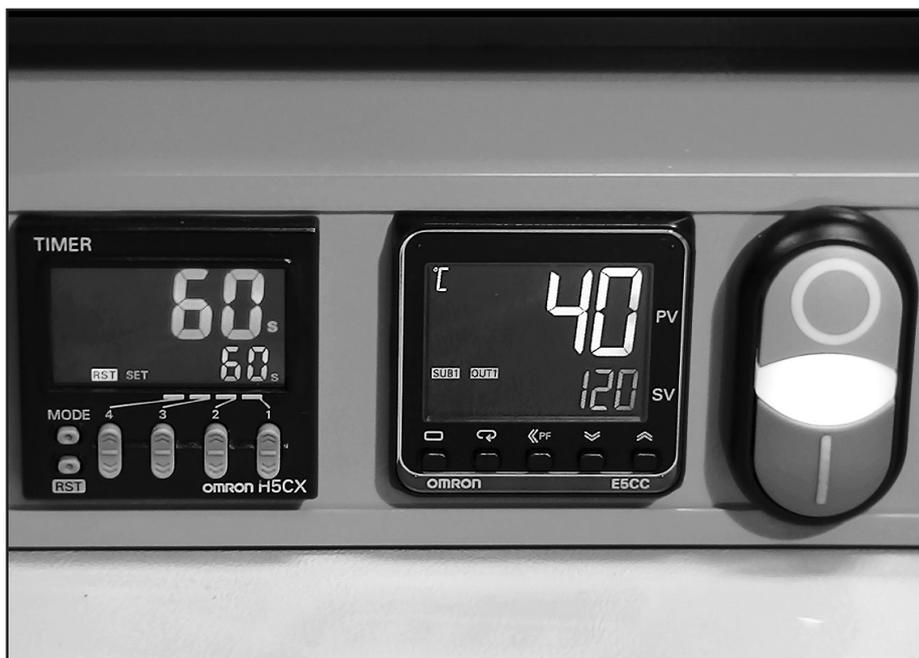
Die Maschine abkühlen lassen, bis die weiße Lampe aufleuchtet (Werkseinstellung 40°C Regler-Temperatur). **Warnung!** Schutzvorrichtung, Klemmbalken und Klemm-Rändelmutter sind nach dem Verbinden heiß. Es ist wichtig für die Sicherheit und für die Qualität der Verbindung, dass die Maschine abkühlt, nachdem eine Verbindung hergestellt wurde.
