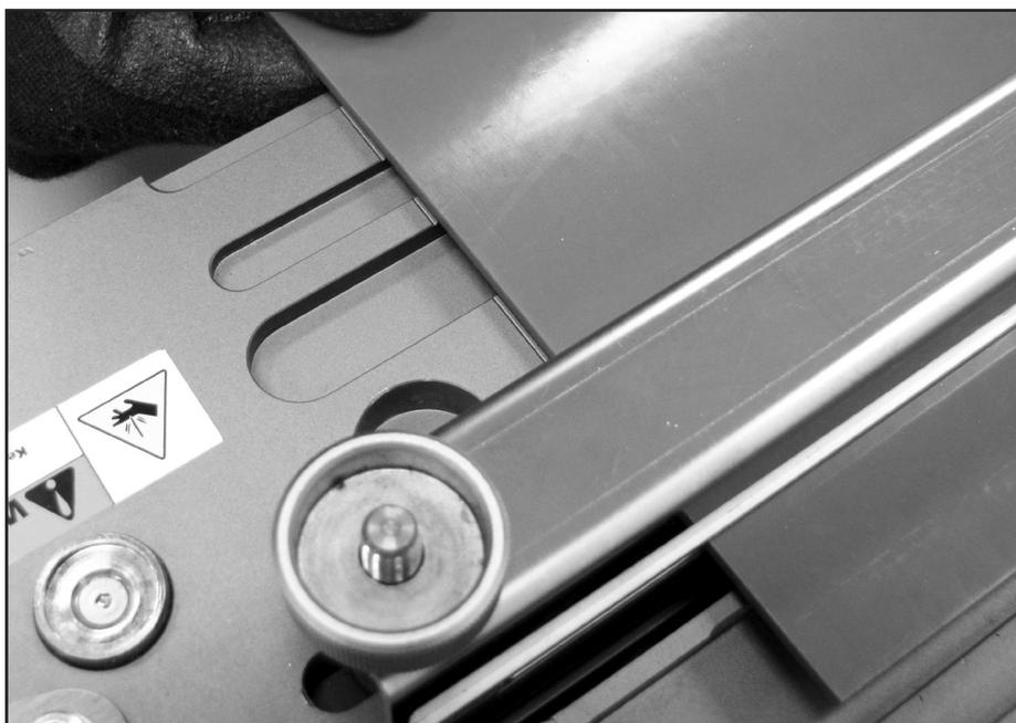
Sicherstellen, dass das Transportband "rechtwinklig" in der Maschine sitzt; entweder indem die Vorrichtung für den Positivtrieb benutzt wird oder durch die Verwendung eines Winkels oder der Markierungen. **Hinweis!** Das zu verschweißende Band sollte mittig in der Presse liegen.
