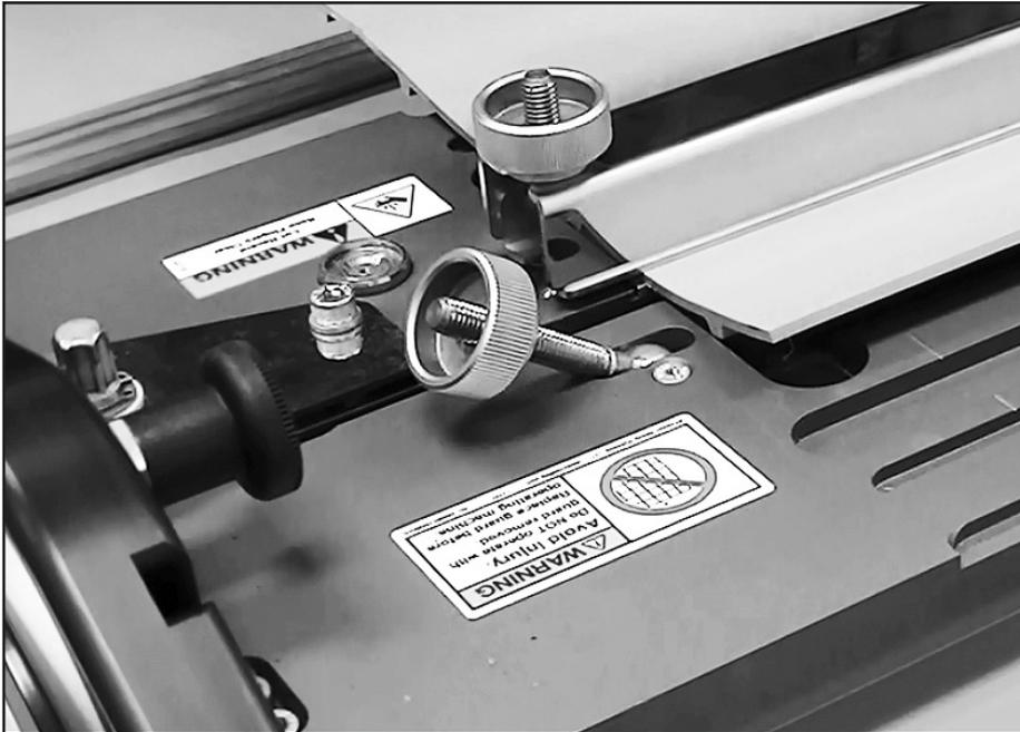
Für Bänder mit Antriebsstegen ist die bevorzugte Vorgehensweise, das Transportband gegen das Ende der Schablone zu schieben, das den Reglern am nächsten ist. Hierdurch wird mehr seitliche Führung (Bandbreite) zur Aufnahme des Schneiddrucks erreicht.
