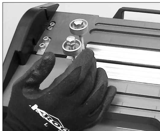
15. Die feste Heizplatte leicht gegen das Schneidmesser bewegen.
