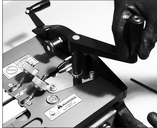
11. Das Schneidmesser etwas aus der Endstellung herausbewegen.
