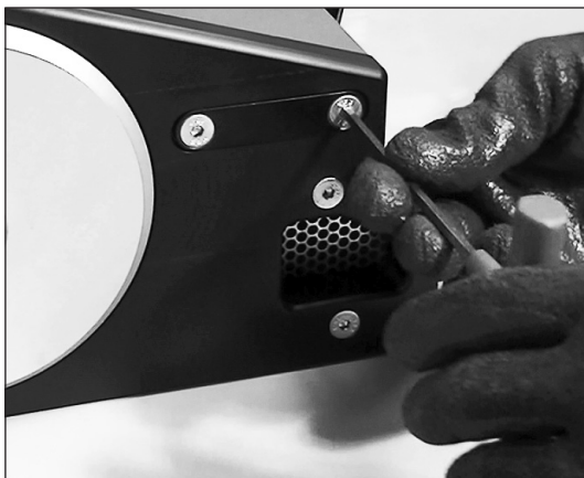
16. Zwei (2) Heizplatten-Arretierschrauben auf der angrenzenden Seite ganz festziehen.
