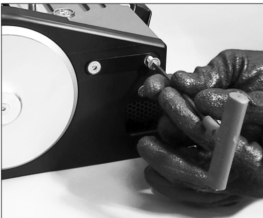
1. Vier (4) Heizplattenschrauben lösen und entfernen.
