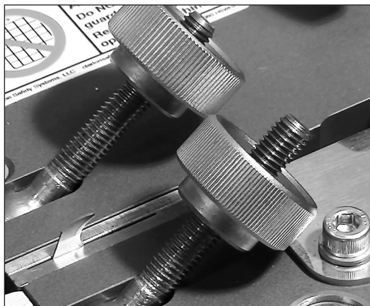
17. Das Schneidmesser zurück bis gerade außerhalb der Endstellung verfahren.
