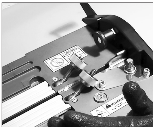
19. Sicherstellen, dass die feste Heizplatte leicht gegen den Blatthalter drückt.
