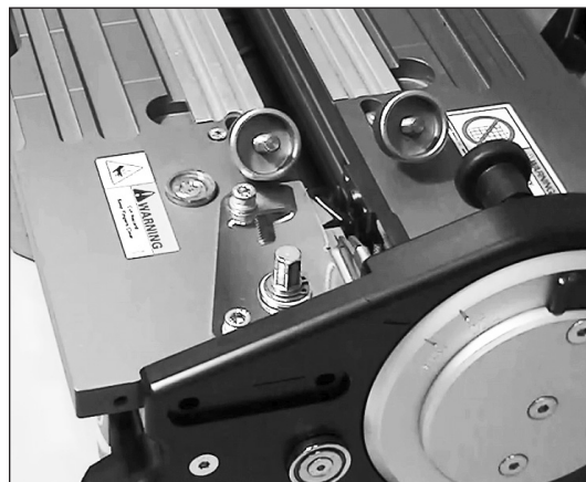
2. Die feste Heizplatte wieder in die Haltenut der vorderen Platte schieben.
