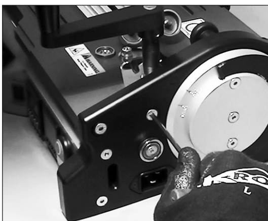
20. Zwei (2) Heizplatten-Arretierschrauben auf der angrenzenden Seite ganz festziehen.
