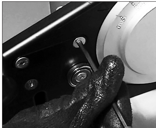
13. Zwei (2) Heizplatten-Arretierschrauben auf der angrenzenden Seite leicht festziehen.
