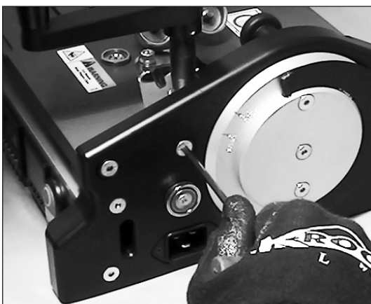
18. Die beiden (2) Heizplattenschrauben an der Reglerseite lösen.
