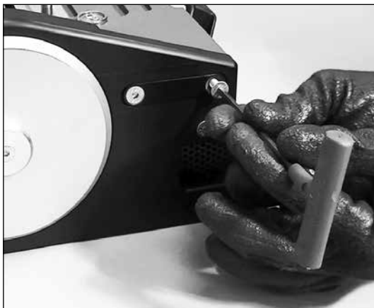
1. Afloje y retire los cuatro (4) tornillos de bloqueo de la placa.
