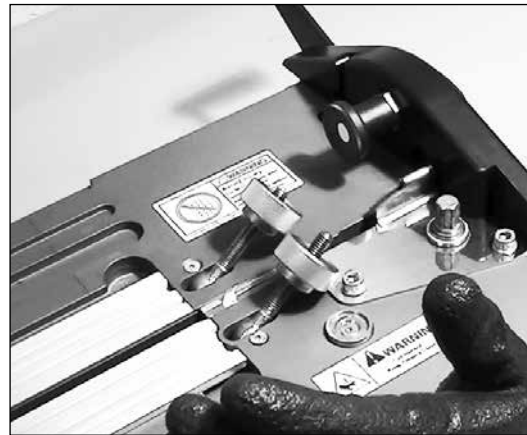
19. Asegúrese de que la placa fija esté ligeramente contra el sujetador de la hoja.
