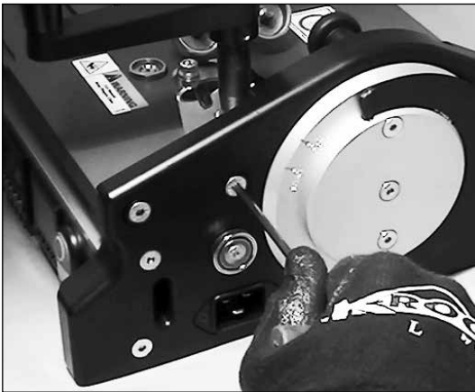
18. Afloje los dos (2) tornillos de bloqueo de la placa que están en el extremo de control.
