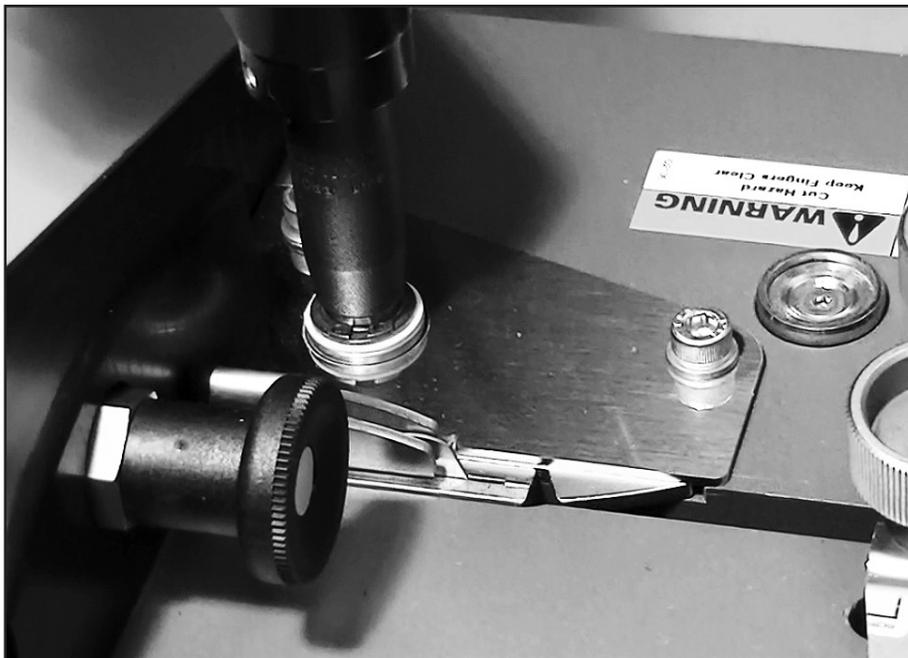
Continúe moviendo la manivela hasta que la hoja llegue a su posición de almacenamiento y el cierre de posición del cortador se active.
