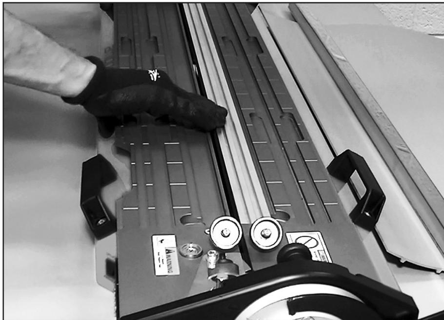
Cambie la plantilla de la banda a la placa opuesta. Repita la preparación del extremo de la banda en el segundo extremo de la banda (pasos C7 al C16).
