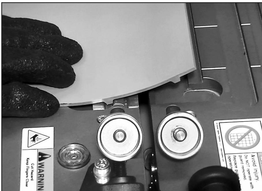
Enganche la banda con la plantilla. Coloque para eliminar un área problema de la banda o sencillamente prepare el extremo de la banda con un corte preciso para el empalme. La banda debe cubrir totalmente la separación entre las placas. ¡Nota! Solo los extremos de la banda preparados con el cortador integrado son suficientemente precisos para acomodar el empalme.
