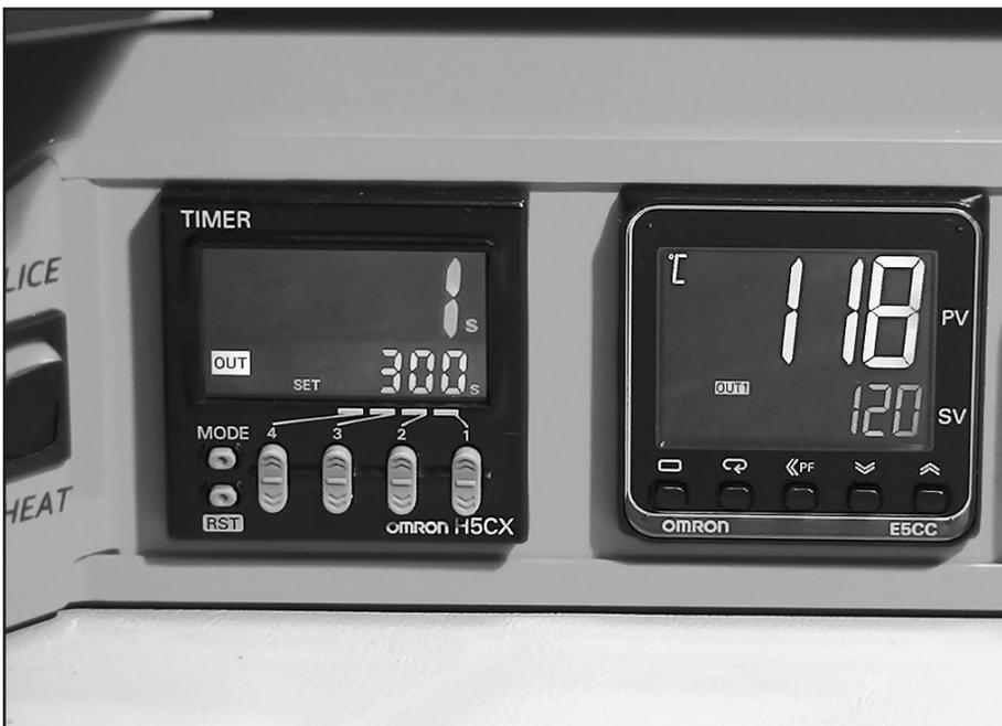
Deje que el período de pre calentamiento termine. Escuchará un sonido cuando termine el ciclo de pre calentamiento. Deje que la máquina y banda se enfríen para preestablecer la temperatura de “inicio del empalme”.
