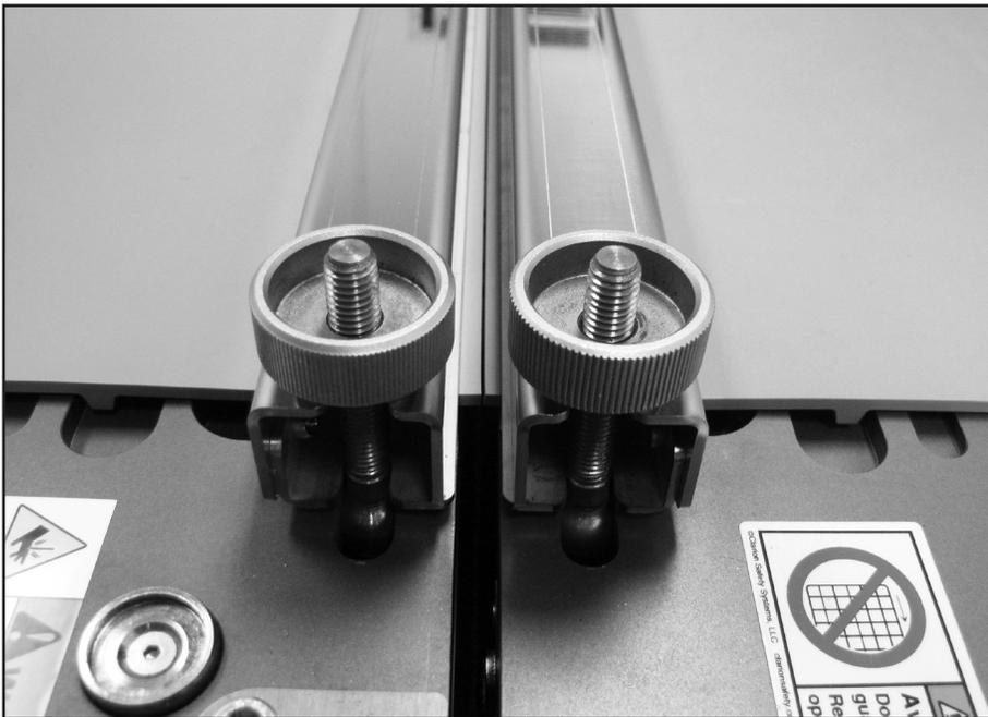
Coloque la palanca del actuador para permitir que los extremos de la banda preparada se sostengan. No debe haber más de 0.1 mm (.004") de espacio a lo largo de las superficies limitadas completas. Si el espacio es mayor o irregular, puede ser necesario volver a preparar los extremos de la banda.
