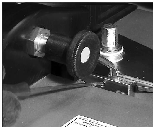
2. Utilice el husillo de rosca de 2 mm proporcionado para aflojar el tornillo de ajuste de retención de la hoja a **1 vuelta como MÁXIMO**. **¡Precaución!** NO afloje demasiado. El tornillo de ajuste es muy corto y se puede zafar y perder.
