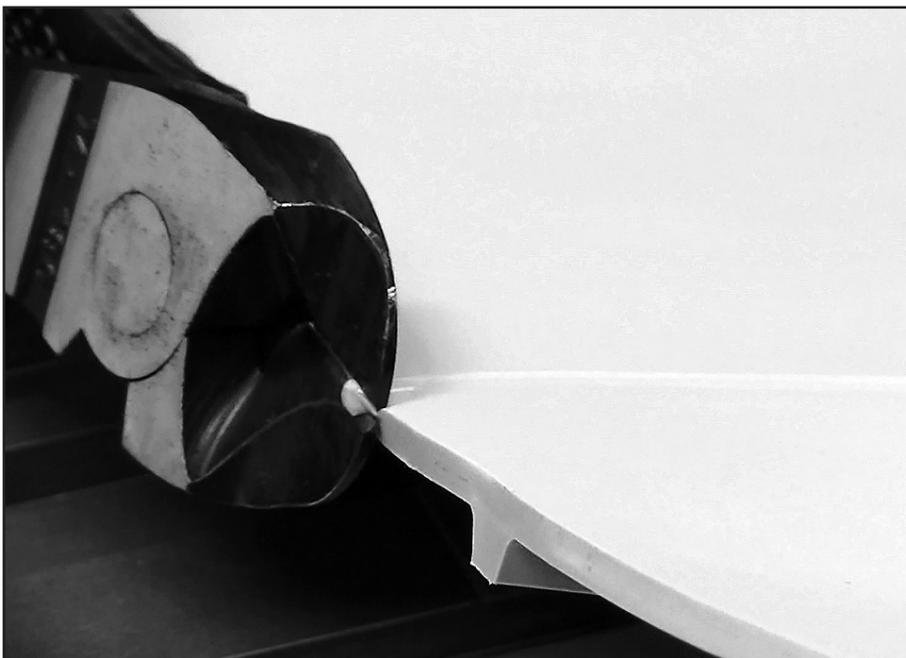
Recorte la capa de soldadura del empalme de los bordes de la banda con el cortador Flexco Unibar. ¡Nota! Los anchos de banda empalmados pueden variar. Si es necesario, haga un corte sesgado en cualquier borde, eliminando cualquier “grada” de los bordes de la banda.
