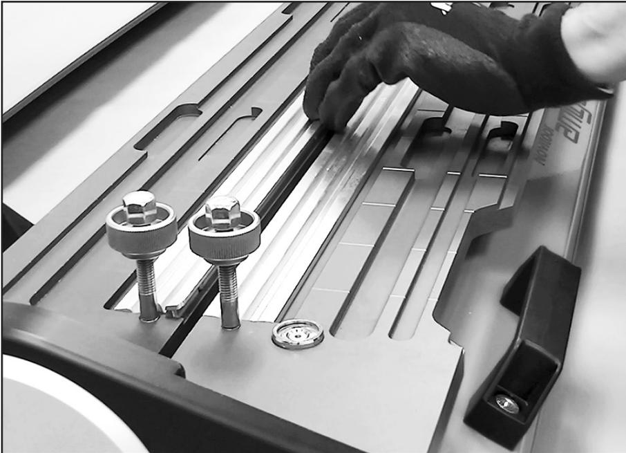
Asegúrese de que las ranuras que reciben la plantilla y placa estén limpias y sin residuos. Las plantillas son direccionales y se adaptan a la dirección correcta. Primero inserte el borde exterior, presione hacia abajo el borde interior para asegurarlo en su lugar.
