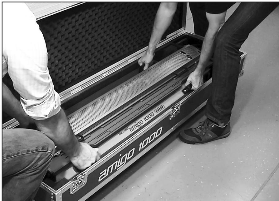
Abra el estuche de transporte y levante la máquina para sacarla del estuche. **¡Precaución!** Se necesitan dos personas para levantar y poner la máquina en su lugar. Coloque la máquina sobre una superficie nivelada con las placas hacia arriba y a nivel. NO aplique corriente eléctrica hasta que la banda esté cortada y sujeta con mordazas, preparada para hacer el empalme. Asegúrese de que el tomacorriente, los controles y la manivela del cortador estén accesibles.
