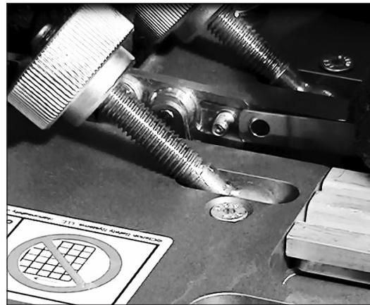
2. Una vez desinstale la tuerca de retención y la arandela Belleville del emisor, comprima manualmente el tensor del resorte del emisor y desenganche el emisor del soporte de retención del bloque del emisor.
