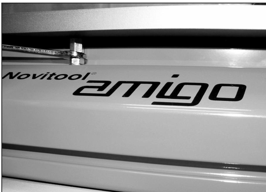
Si la superficie de la banda no se puede alinear por la tensión de la tuerca de mariposa, la placa fija se puede ajustar con dos tornillos de sujeción. Asegúrese de que los tornillos de sujeción estén fijos en su lugar, con contratuercas una vez logre la alineación de la superficie de la banda.
