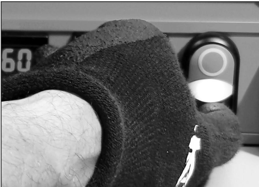
Cuando la máquina se enfríe a la temperatura de “inicio de empalme” y la luz se ilumine, presione de inmediato el botón de inicio verde para iniciar el ciclo de calentamiento de empalme. Observe cuidadosamente la máquina durante el ciclo de empalme.
