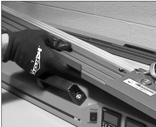
3. Levante el lado de la placa ubicado en el extremo opuesto de control.
