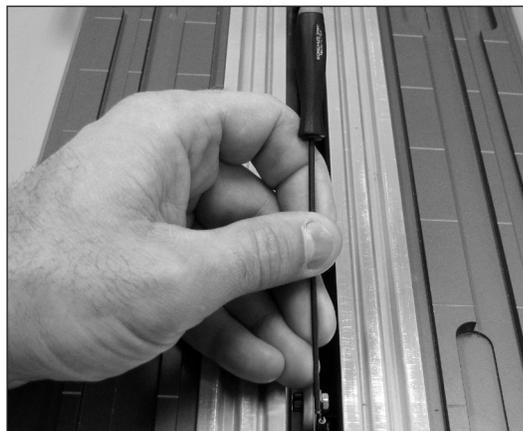
**11.** Retire el protector. Utilice un husillo de rosca de 2 mm para verificar el espacio de 2 mm entre el emisor y la pila termoeléctrica. Esta es una configuración de fábrica y no debe cambiar a menos que la termocupla haga contacto durante el reemplazo del emisor. Ajuste con cuidado la pila termoeléctrica solo si es necesario. Haga presión ligeramente contra la termocupla para ajustar la posición. La altura de la termocupla no está ajustada.
