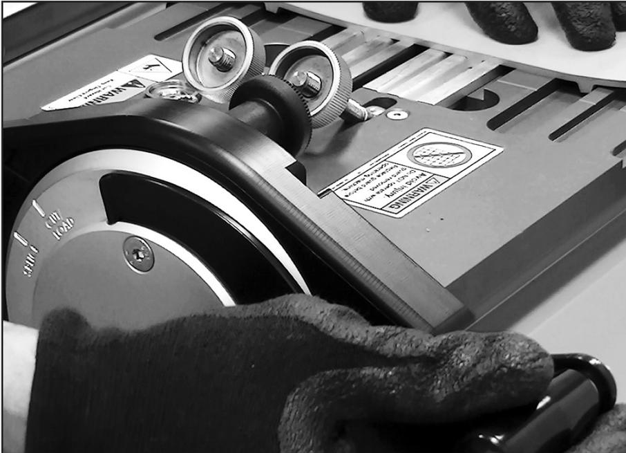
Coloque la banda con las barras de impulso enganchadas a ambas plantillas. Gire la palanca de accionamiento para aflojarla entre las posiciones “Cut/Load” (Cortar/cargar) y “Splice” (Empalme).
