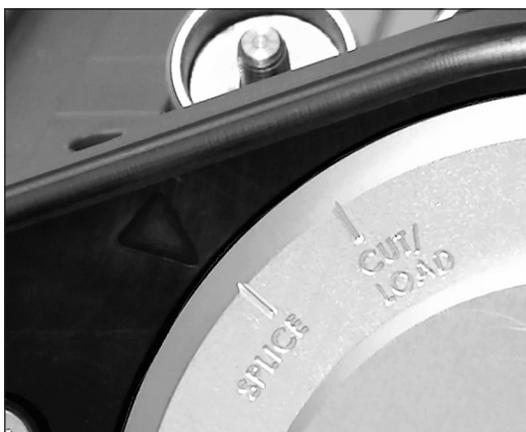
1. Gire la palanca del actuador a la posición SPLICE (empalme). **¡Precaución!** El emisor está expuesto durante el funcionamiento. Tenga cuidado de dañarlo.
