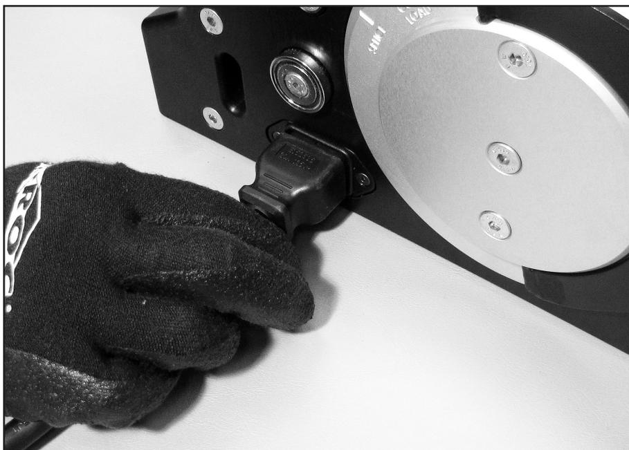
Seleccione el cable eléctrico adecuado y conéctelo al tomacorriente de la máquina.
