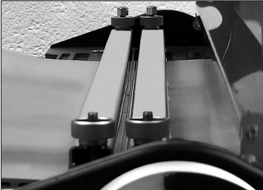
Después de que la señal de luz indique la finalización del proceso de empalme, retire el protector. **¡Precaución!** El protector, las barras de mordaza y las tuercas de mariposa de mordaza siguen estando calientes después de que finaliza la indicación del proceso.
