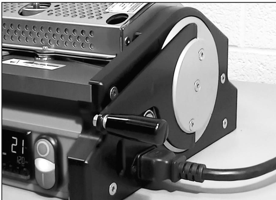
Abra las placas y levante el emisor a la posición de calentamiento con la palanca del actuador.
