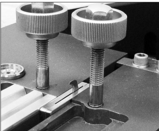
14. Gire el sujetador de la hoja completamente hacia el lado opuesto de la máquina.
