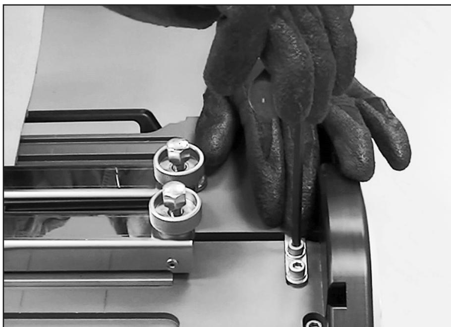
Apriete los dos tornillos de dado con una llave de tubo hexagonal de 5 mm. Repita para la placa de tope de placa en el extremo opuesto de las placas.
