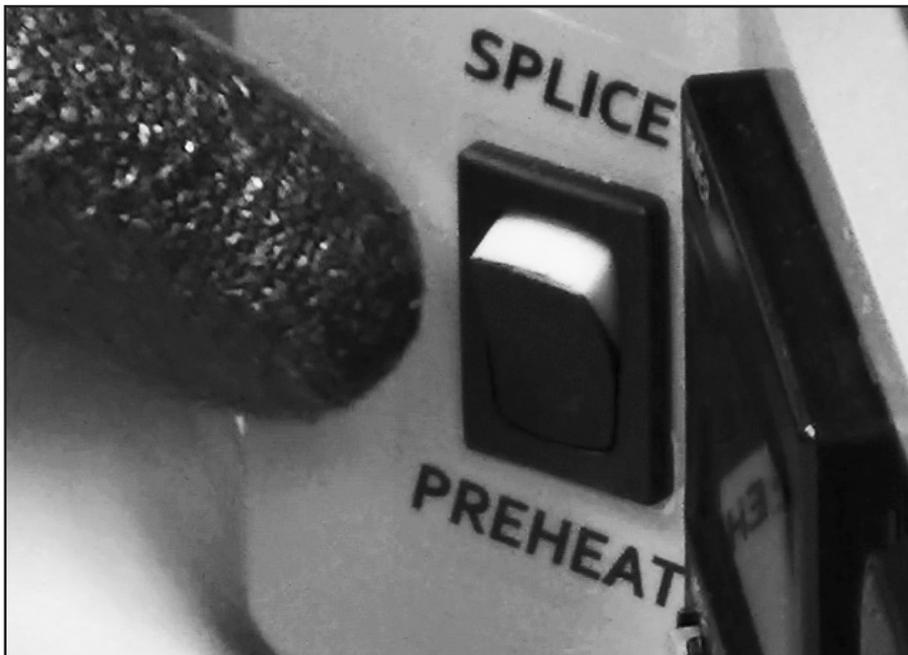
Coloque el interruptor de modo de calentamiento en la posición PREHEAT (pre calentamiento).
