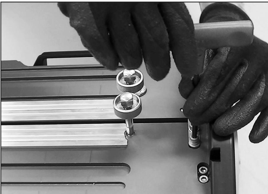
En la placa de tope de la placa, afloje los dos tornillos de dado con una llave de tubo hexagonal de 5 mm. Repita para la placa de tope de placa en el extremo opuesto de las placas.
