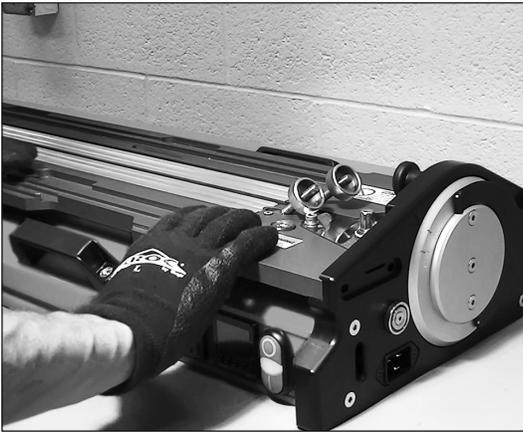
10. Bloquee el disco de accionamiento en la posición de corte/carga.
