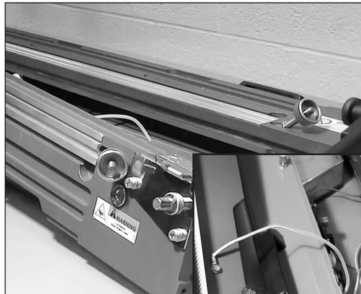
4. Gire el lado de la placa terminal de control hacia afuera de las ranuras de retención de la placa delantera. Coloque la placa cerca de la máquina. **¡Precaución!** Hay un cable de tierra conectado a la placa fija. Tenga precaución para evitar que este cable y la conexión se dañen.
