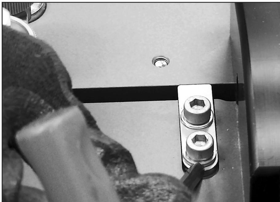
Mueva la placa de tope de placa para que haga contacto con la superficie de la placa fija. Repita para la placa de tope de placa del extremo opuesto, mueva para que haga contacto con el sujetador de la hoja.
