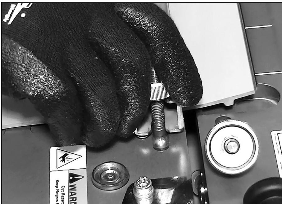
Instale una barra de la mordaza ajustada sobre la banda instalada y la plantilla.
