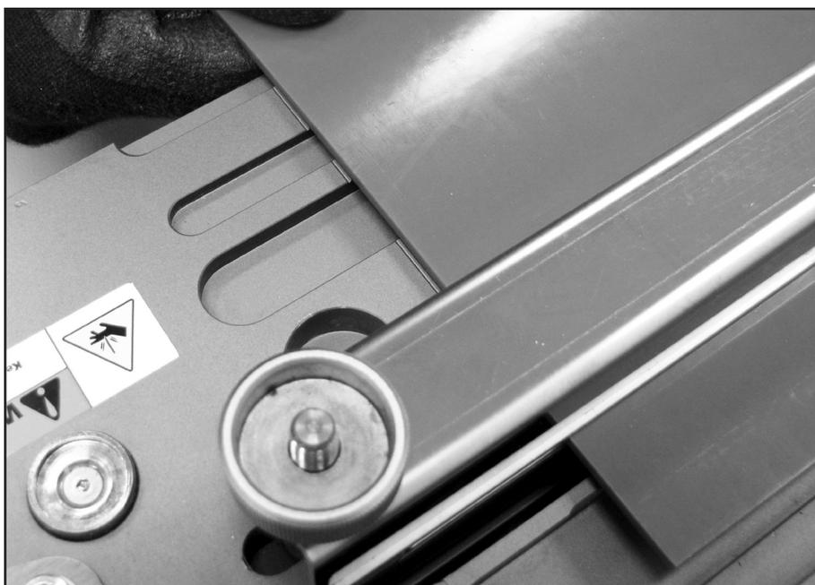
Asegúrese de que la banda esté colocada en “escuadra” con la máquina ya sea con el enganche de la característica de impulso positivo o al utilizar una escuadra o marcas de alineación. **¡Nota!** Los anchos de banda deben estar centrados en la máquina para el empalme.
