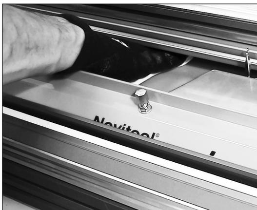
7. Levante el emisor para acceder por debajo de la placa de deslizamiento y limpiar el lado opuesto. Baje el emisor después de la limpieza.
