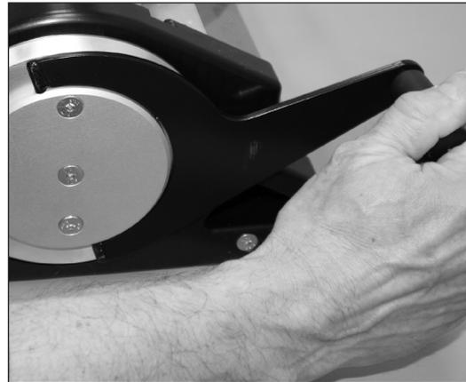
6. Gire la palanca del actuador/disco de compresión para cerrar las placas.
