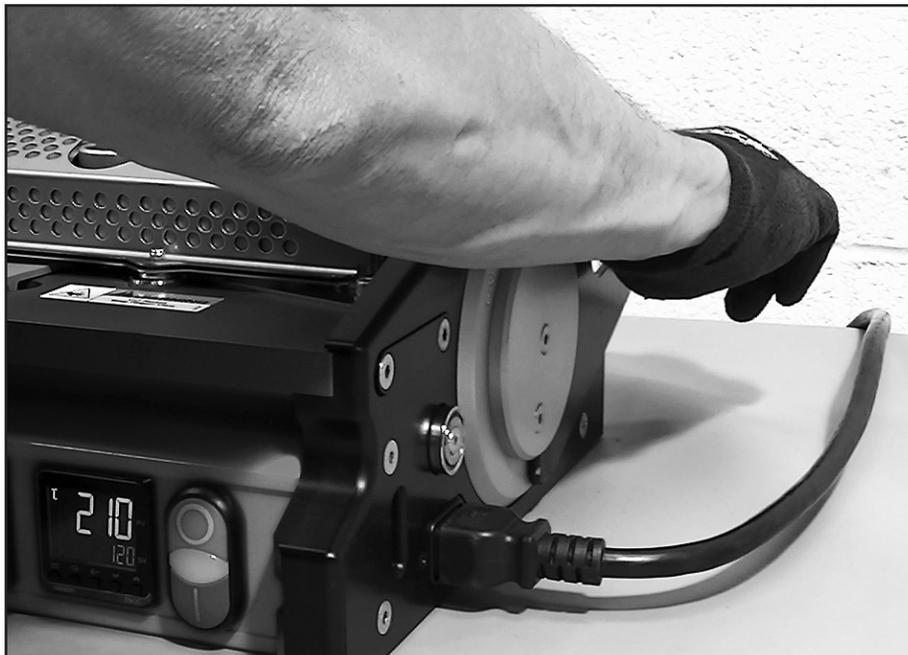
Un tono de señal audible marca la conclusión del ciclo de calentamiento de empalme. Inmediatamente al escuchar el tono (en 1 segundo), gire la palanca del actuador a la posición de empalme y manténgala por aproximadamente 5 segundos. No fuerce la palanca del actuador contra el tope interno.
