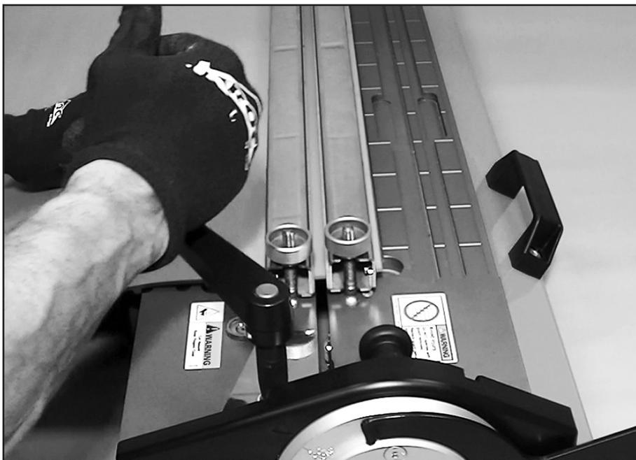
Utilice la manivela del cortador y aplique velocidad de arranque uniforme para jalar la hoja del cortador hacia el extremo de control. **¡Importante!** No detenga la acción de corte, particularmente cuando la hoja entra o sale de la banda existente. Si lo hace, provocará un corte disperejo.
