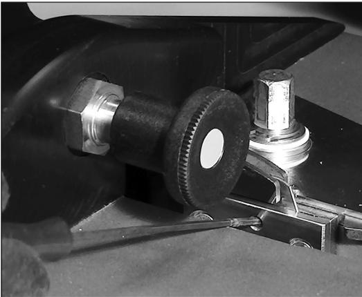
5. Asegúrese de que la hoja esté debidamente colocada en el sujetador de la hoja. Apriete el tornillo de ajuste de retención de hoja.
