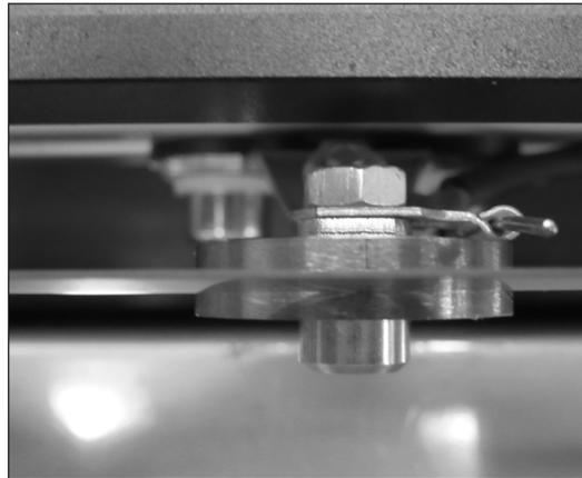
9. Asegúrese de que el emisor esté colocado en (o sobre) el rodillo de soporte del emisor. ¡Nota! El emisor puede tener un leve "arco" para evitar el contacto inicial con el rodillo de soporte. Esto se eliminará después de varios ciclos de calor de acondicionamiento. Asegúrese de que el emisor no esté en contacto con la termocupla.
