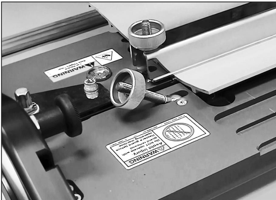
Para las bandas de impulso positivo, una práctica preferida es colocar la banda totalmente contra el extremo de la plantilla que está más cerca de los controles. Esto puede proporcionar soporte lateral adicional (ancho de banda) para resistir las cargas de corte.
