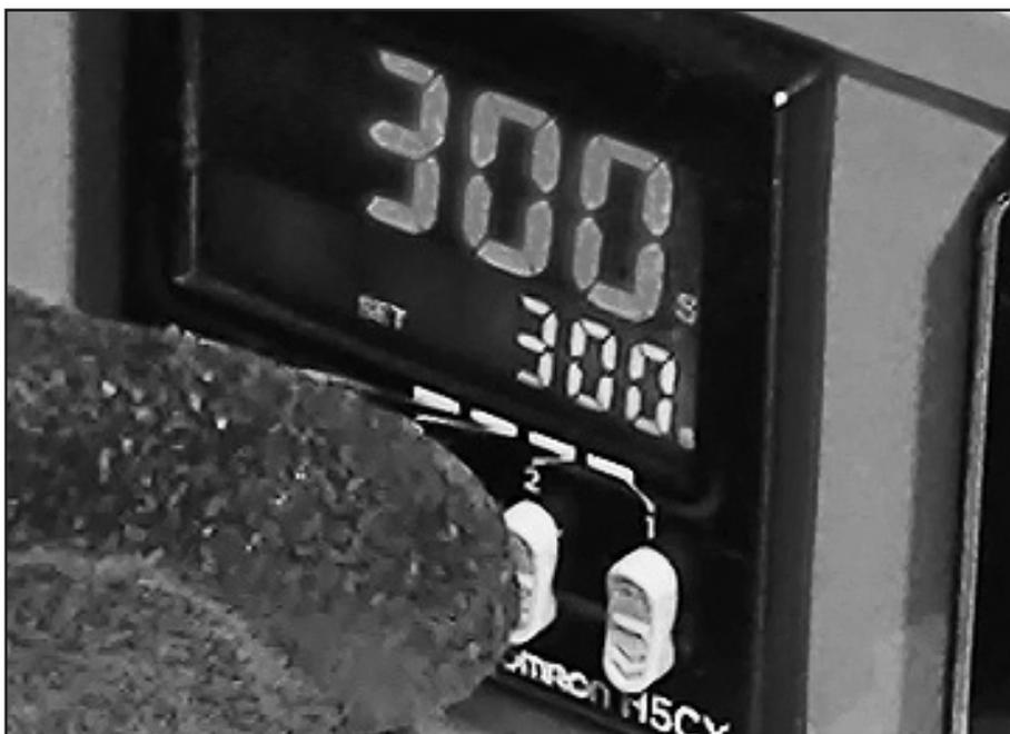
Ajuste el tiempo de pre calentamiento deseado (en segundos) en el temporizador.
