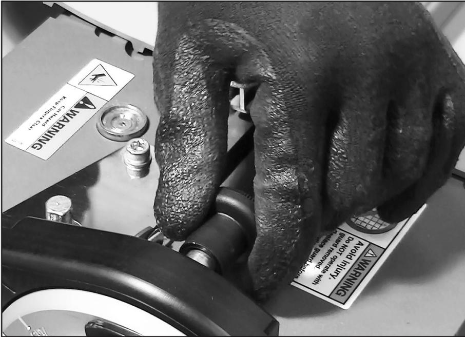
Con ambos extremos de la banda preparada sujetos con mordaza en la máquina, saque y gire el pasador de bloqueo para liberarlo de la posición bloqueada. **¡Nota!** El pasador está colocado para no restringir el movimiento de la palanca del actuador durante el empalme.
