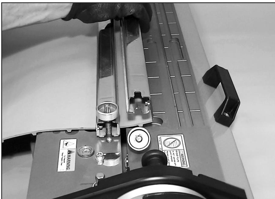
Sujete con mordaza sin apretar el resto de la barra de mordaza para banda. NO APRIETE LA BARRA DE MORDAZA. Esta barra de la mordaza se instala para proporcionar protección de la hoja del cortador. Es importante permitir el alivio de la banda en el lado sin apretar de la hoja de corte durante el proceso de corte.
