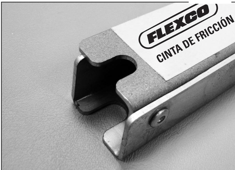
Para la banda plana impulsada por tensión o bandas de impulso positivo con características de impulso segmentadas, una práctica preferida es utilizar la cinta de fricción de Flexco (artículo No. 08604) instalada sobre las barras de la mordaza. La cinta de fricción ayuda a fijar la posición de la banda durante las operaciones de corte y empalme. Puede utilizar un paño húmedo para limpiar la superficie de la cinta de fricción.
