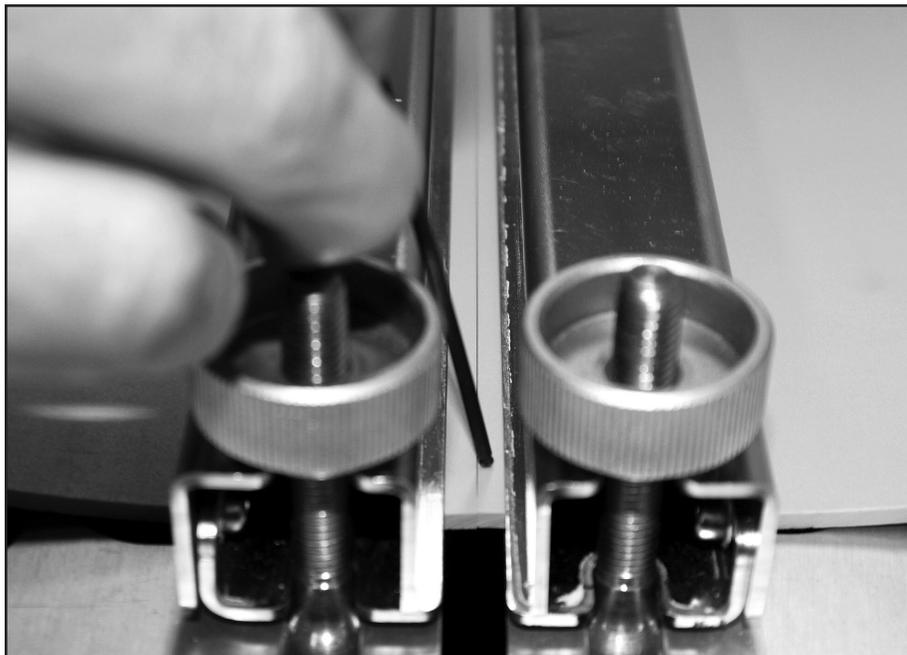
Con el husillo de rosca de 2 mm que se proporciona o una “sonda” alterna, determine si los extremos de banda preparados están alineados de manera uniforme y “verticalmente”. No se debe sentir ninguna “grada” al mover la sonda a lo largo del corte. Si observa que hay una grada, intente alinear las superficies de la banda al apretar (o aflojar) las tuercas de mariposa de mordaza.
