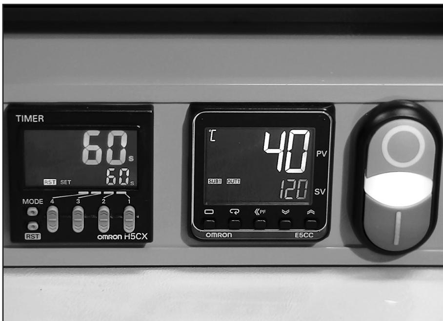
Deje que la máquina se enfríe hasta que la luz blanca se ilumine (temperatura de control de 40 °C de ajuste de fábrica). **¡Advertencia!** El protector, las barras de mordaza y las tuercas de mariposa de mordaza están calientes después del empalme. Es importante para la seguridad e integridad del empalme dejar que la máquina se enfríe después de hacer el empalme.
