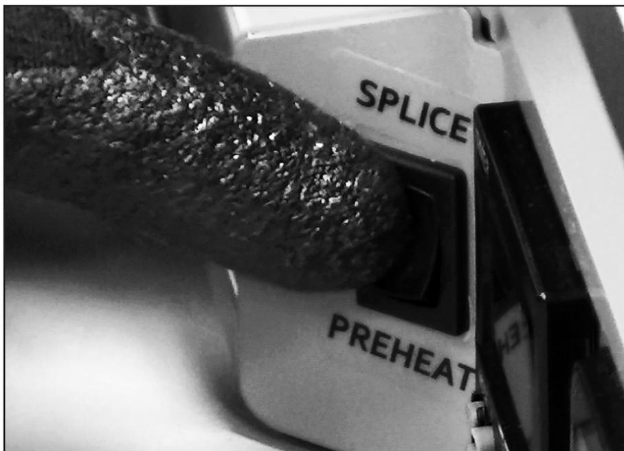
Durante este período de enfriamiento, ajuste el interruptor basculante de modo de calentamiento a la posición SPLICE (empalme).
