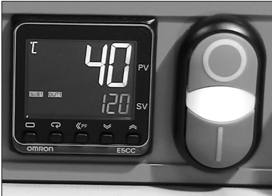
La temperatura de “inicio del empalme” de ajuste preestablecida de fábrica es de 40 °C. Se encenderá una luz blanca en el interruptor de inicio/parada cuando la temperatura de control esté en o debajo del ajuste.
