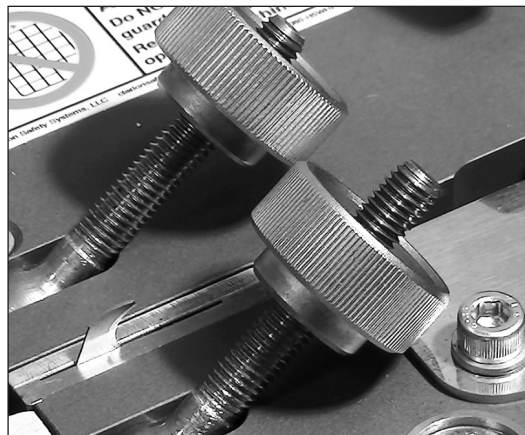
17. Gire otra vez el sujetador de la hoja justo hacia fuera del área de almacenamiento.
