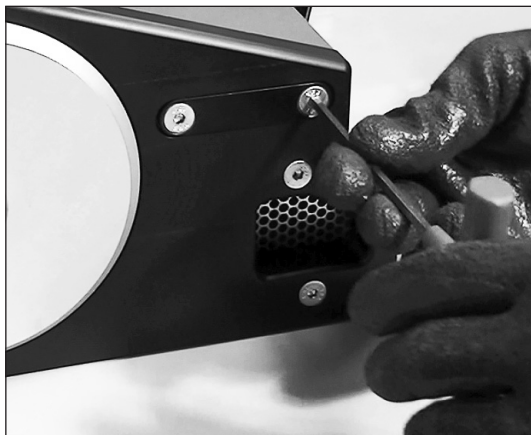
16. Apriete por completo los dos (2) tornillos de bloqueo de la placa lateral adyacente.
