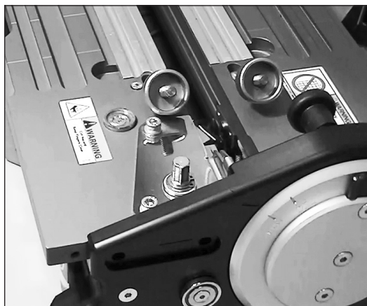
2. Faites glisser la plaque fixe vers l'arrière dans les rainures de retenue de la plaque avant.
