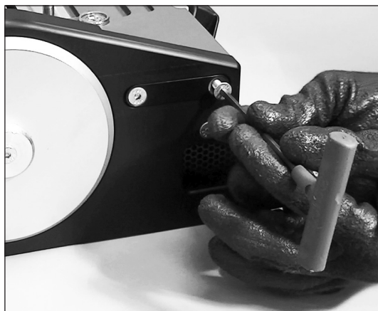
1. Desserrez et retirez les quatre (4) vis de blocage de la plaque.
