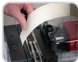
La estación de enfriamiento incorporado asegura el material de parche con la cinta de lavado
