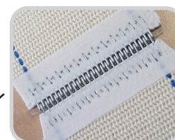
Los puntos de engrapado se cubren con el parche durante la instalación
