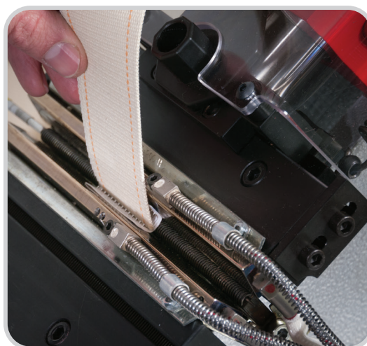
Las Grapas individuales se aseguran con el material de parche
