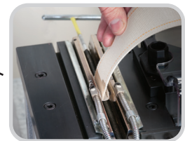
Beheizbare Pressbacken erhitzen den Kleber während des kurzen Montagevorgangs
