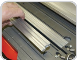
แผ่นแม่แบบรอยต่อ แบบใช้แทนกันได้ ใช้เพื่อเว้นระยะการ ต่อรอยอย่างแม่นยำ สำหรับสายพานที่มา จากผู้ผลิตหลายราย
