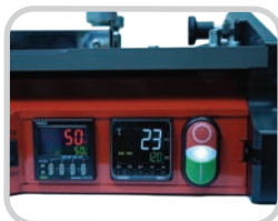
ระบบควบคุมเวลา ดิจิทัลพร้อมส่วนตั้ง ค่า รอยต่อที่รวดเร็ว และ ไม่ยุ่งยากเช่น ส่วนปรับตั้งค่าความ ร้อน เบื้องต้นที่สามารถใช้ไล่ความชื้นและป้องกัน โพรงอากาศ
