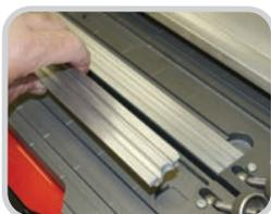
**Die austauschbaren Verbindungsschablonen** ermöglichen teilungsgenaue Spleißverbindungen von Bändern verschiedener Hersteller
