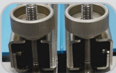
冷却区： 输送带端对焊在一起时确保装置内部的加热器停止并冷却。
