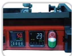
数字时间控制具有快 速、简单的拼接设置； 预热设置可用于除去水 分并避免出现针孔
