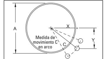
A = Diámetro de la polea + recubrimiento y banda
