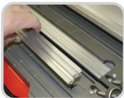
Template Sambungan yang Dapat Ditukar untuk penyambungan sabuk secara presisi dari berbagai pabrikan sabuk
