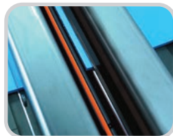
Pemanasan Tanpa Kontak menghasilkan jumlah leburan yang terkontrol tanpa bersentuhan dengan sumber panas
