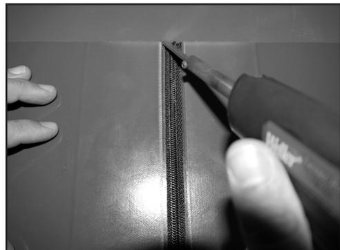
17. Einzelne Spiralen an der Außenkante mit einem Seitenschneider entfernen. Dadurch soll verhindert werden, dass sich die Spirale im Gestell der Förderanlage verfängt. Das Gewebe der Spiralnaht an beiden Bandenden mit einem LötKolben fixieren, um ein Ausfransen zu vermeiden. Den Kunststoff-Kupplungsstab einsetzen.
