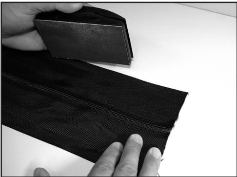
2. Das Gewebe mit einem Schleifklotz/Schleifpapier von oben und unten anrauen, sodass die Fasern frei liegen, um die mechanische Haftfähigkeit zu verbessern.
