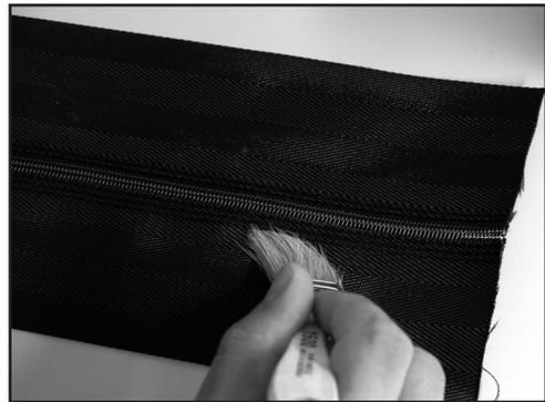
4. Mit einem geeigneten Pinsel eine dünne Schicht der angerührten Haftgrundierung auf das obere und untere Gewebe der Spiralnaht auftragen. Haftgrundierung unmittelbar bis zur Nahtlinie der Spiralen auftragen, dabei die Spiralen selbst nicht bestreichen.
