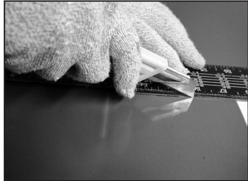
16. Das Band aus der Aero™-Presse entfernen. Den Metallstab mit einer Zange aus der Spiralnaht entfernen. Überschüssiges Bandmaterial mit einem Winkel und einem Messer entfernen, um die Kanten des Bandes zu bearbeiten.
