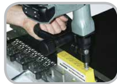
Instalação de rebitador elétrico
