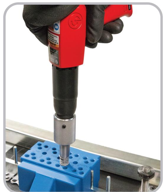
*Instalación de la herramienta de Instalación de remaches neumática*
