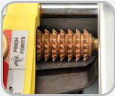
Rodillos impulsores delanteros que sujetan fuertemente la banda al inicio del desbastado para evitar deslizamientos.
