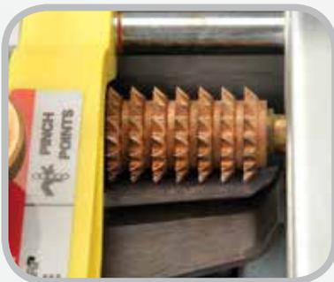
Rodillos impulsores delanteros que sujetan fuertemente la banda al inicio del desbastado para evitar deslizamientos.
