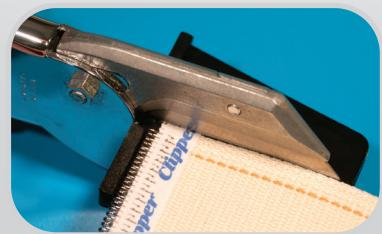
As cortadoras tipo pinças podem ser usadas para cortar pontas de correia e cantos de entalhe do reparo do grampo instalado para evitar que as bordas se prendam durante a operação.
