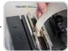
*A prensa aquecida ativa a cola durante o rápido processo de instalação*
