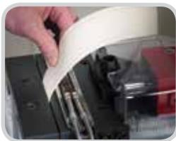
*A estação de arrefecimento integrada assegura a ligação adequada do material de reparo com a correia*
