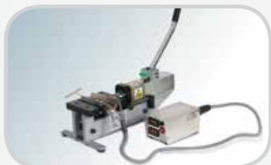
O PRO-120 oferece um método manual, porém rápido, para instalar grampos de reparo. A ferramenta de instalação de ganchos inclui uma estação de aquecimento/pressão e uma estação de arrefecimento.
