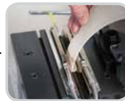
Las mordazas calientes activan la goma durante el proceso de instalación rápida
