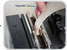
快速安装过程中加热夹爪 活化粘胶
