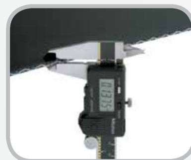
Mida el espesor de la banda
