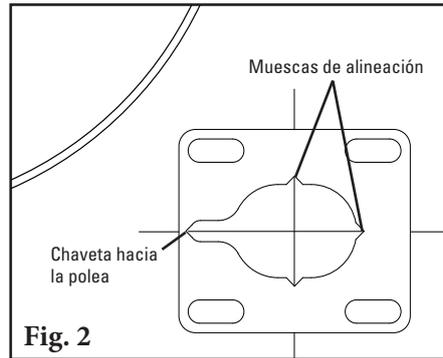
**NOTA:** Los recortes del orificio están ranurados para un ajuste posterior, si fuera necesario.
