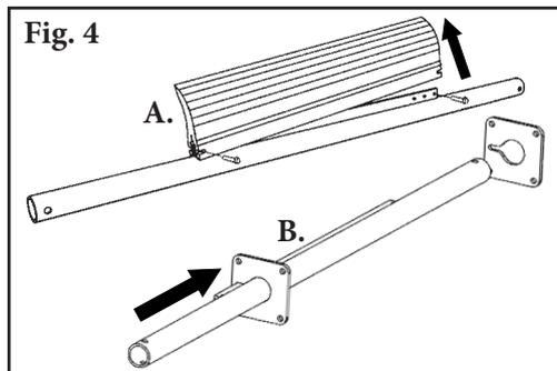
4. **Instale el eje.** Retire los seguros de la hoja y las hojas del eje e inserte el eje entre las placas de montaje (Fig. 4).
