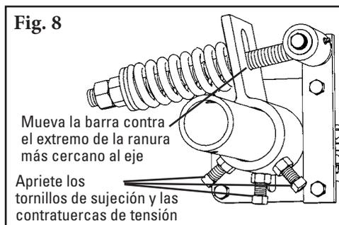
8. **Aplique tensión a la hoja en la banda.** Gire la hoja hasta que haga contacto con la banda. Mientras sostiene el buje del resorte fijo sobre el brazo de torsión, gire el brazo de torsión hasta que el brazo del pivote quede contra el extremo de la ranura más cercana al eje. Apriete los tornillos sujetadores y las contratuercas de tensión en el brazo de torsión (Fig. 8). **NOTA:** El brazo de torsión debe estar contra la placa de montaje.
