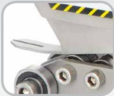
Los cojinetes de bola sellados apoyan la banda durante el corte y proporcionan una alimentación casi libre de fricción de la cortadora sobre la superficie de corte.
