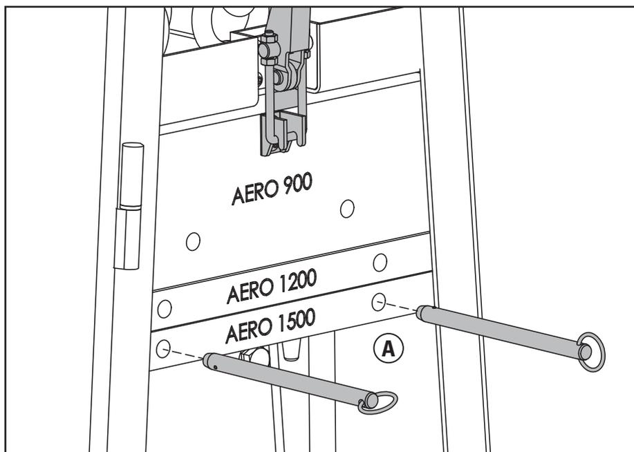
Wenn die Verriegelung der Gewichte geschlossen ist, halten Sie die Gewichte von Hand (Position A), entfernen die Stifte und senken die Gewichte ab; dabei die Finger nicht einklemmen. Halten Sie das verbliebene (Aero 900) Gewicht (Position A), lösen Sie die Gewichtsverriegelung und lassen das Aero 900 Gewicht ab. Meiden Sie die Punkte, wo Sie sich die Finger einklemmen können!
