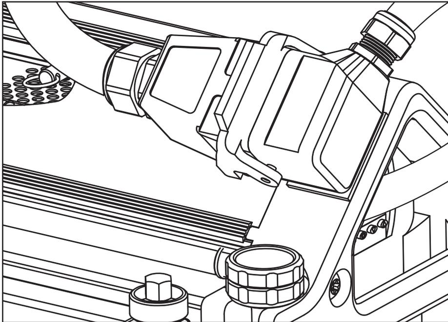
Wenn Sie die Versorgungskabel-Verlängerung verwenden, sichern Sie die Steckverbinder im oberen Balken an der Oberseite der Aero Presse mit einem Klettverschluss-Streifen.
