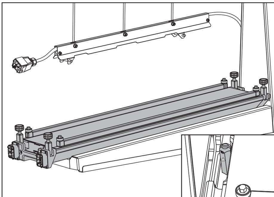
Setzen Sie den unteren Balken der Aero Presse in den Träger, wobei der Positionierstift nach oben durch den Pressenriff gegenüber dem Steuerende ragt. Vorsicht: Wo der Positionierstift die Presse berührt, kann man sich die Finger einklemmen.
