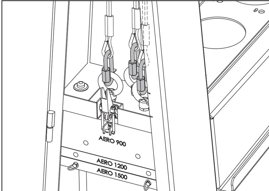
Folgen Sie den Seilzügen von der Seilrolle im oberen Balken von der Rückseite des Aero Stand aus, um sie richtig zu positionieren. Befestigen Sie die Seilzüge mit den bereitgestellten Karabinerhaken.
