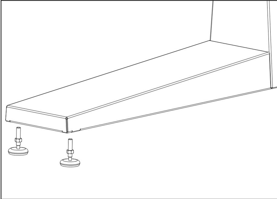
Sicherstellen, dass die Kontermuttern auf die Gewindestangen der Nivellierfüße (wie gezeigt) geschraubt sind, bevor diese eingedreht werden. Drehen Sie zwei Nivellierfüße (Punkt # 7.1) in den Fuß des Aero Stand (Punkt # 3). Darauf achten, dass die Nivellierfüße vollständig in die Aufnahmen eingeschraubt sind.
