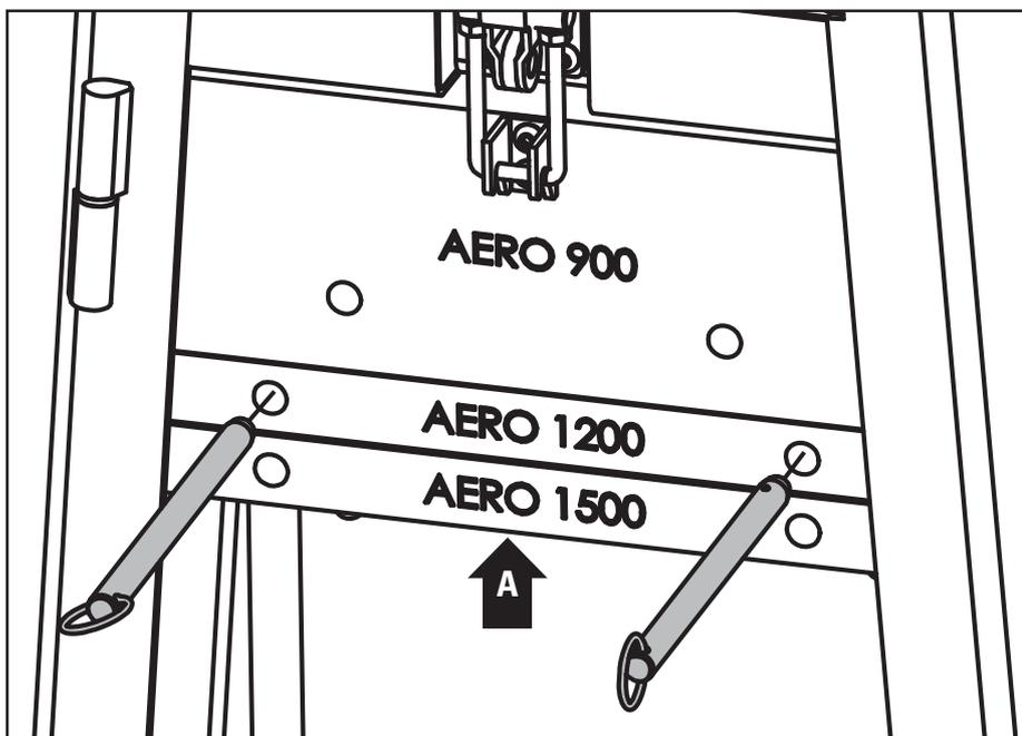
Wenn eine Aero 900 oder 1200 in den Ständer montiert ist, sicherstellen, dass die Gewichts-Verriegelung geschlossen ist und die Gegengewichte (Position A) mit der Bezeichnung AERO 1500 und 1200 halten. Entfernen Sie die Stifte aus dem Aero 1500 Gegengewicht und setzen Sie sie in das Gegengewicht ein, das der Aero Presse im Ständer entspricht. Stellen Sie sicher, dass beide Gewichtsstifte vollständig eingeschoben sind. Meiden Sie die Punkte, wo Sie sich die Finger einklemmen können!
