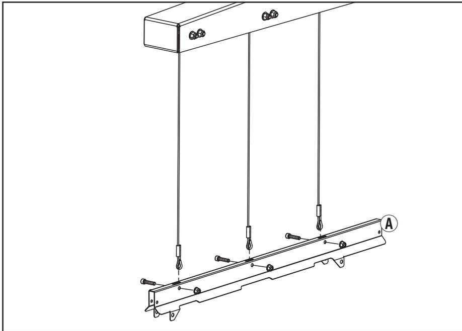
Mit dem längeren Ende (A) in Richtung der Säule, befestigen Sie die Hebeschiene (Punkt # 5) an den drei Seilzügen, die vom oberen Balken herunter hängen, mit drei M8 x 35 mm-Schrauben (Punkt # 7.8) und drei M8-Muttern (Punkt # 7.11).
