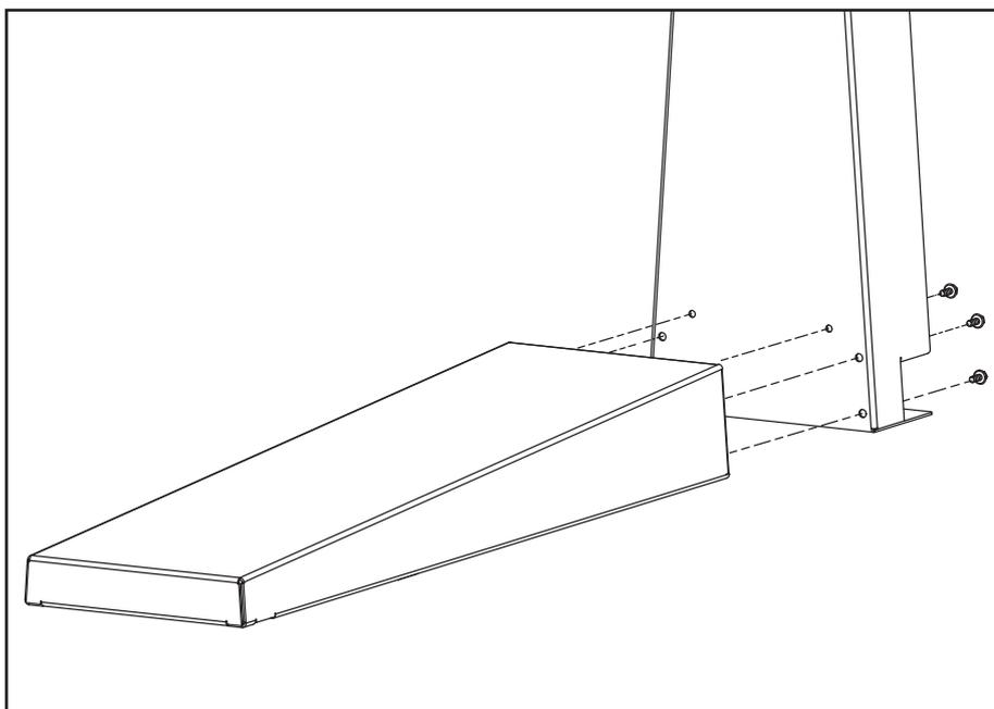
Mit sechs M8 x 20 mm-Schrauben (Punkt # 7.3) den Fuß (Punkt # 3) an die Säule (Punkt # 1) schrauben. Hinweis: Alle Schrauben anfangs nur lose eindrehen und erst anziehen, nachdem alle montiert sind.
