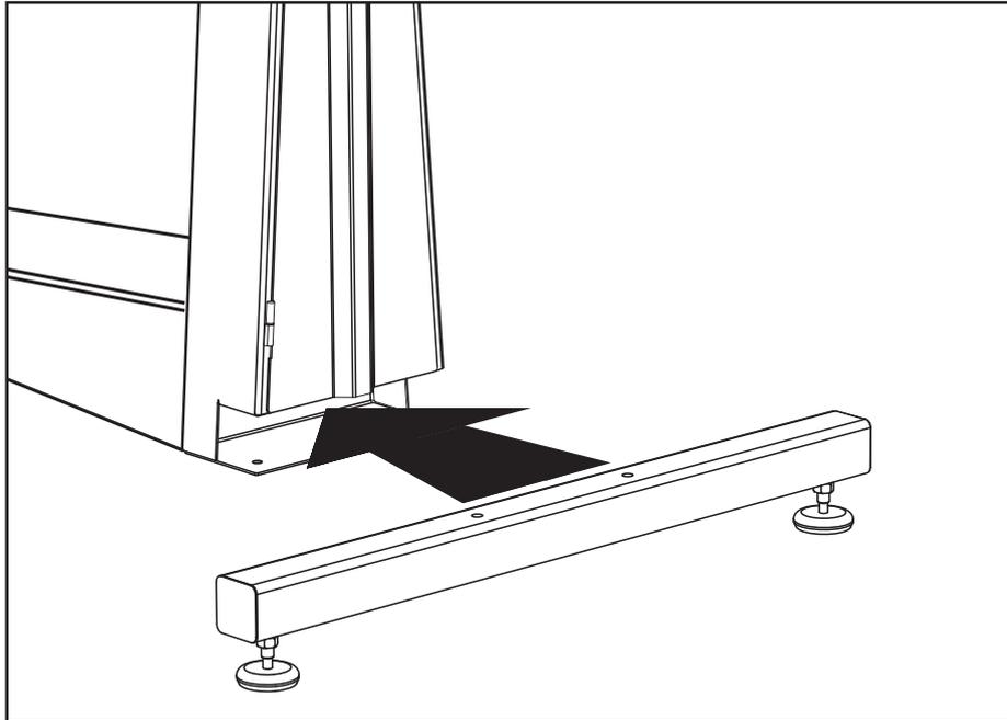
Mit zwei M12 x 100 mm-Schrauben (Punkt # 7.6) und zwei M12-Muttern (Punkt # 7.5) montieren Sie die Querstütze (Punkt # 6) in die Säule (Punkt # 1).
