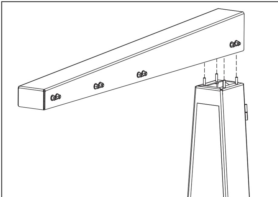
Mit vier M8 x 30 mm-Schrauben (Punkt # 7.4), montieren Sie den oberen Balken (Punkt # 2) an die Säule (Punkt # 1). **Hinweis:** Alle Schrauben anfangs nur lose eindrehen und erst anziehen, nachdem alle eingedreht sind.
