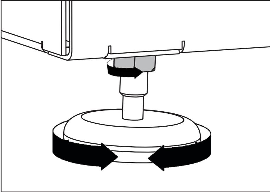
Wenn der Aero Stand betriebsbereit steht, drehen Sie die Nivellierfüße nach Bedarf, um sicher zu sein, dass der Ständer waagrecht steht. Dabei sicherstellen, dass die Gewinde der Nivellierfüße nicht zu weit herausgedreht werden. Dann alle Kontermuttern der Nivellierfüße gegen den Rahmen festziehen.
