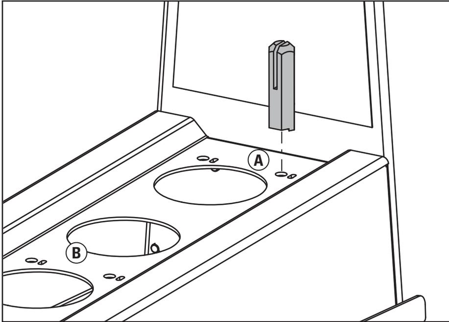
Bauen Sie den Positionierstift (Punkt # 7.13) in den Träger (Punkt # 4), indem Sie eine M10 x 20 mm-Schraube (Punkt # 7.12) von unten eindrehen. Position A für Aero 1200 und 1500. Position B für den Aero 900. Der Stift ist so geformt, dass er nur in der richtigen Stellung eingesetzt werden kann.
