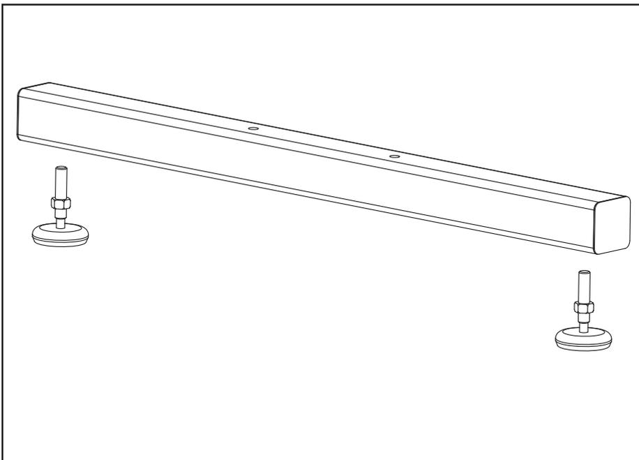
Sicherstellen, dass die Kontermuttern auf die Gewindestangen der Nivellierfüße (wie gezeigt) geschraubt sind, bevor diese eingedreht werden. Drehen Sie zwei Nivellierfüße (Punkt # 7.1) in die Querstütze (Punkt # 6). Darauf achten, dass die Nivellierfüße vollständig in die Aufnahmen eingeschraubt sind.
