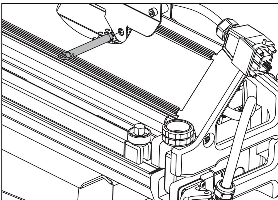
Den oberen Balken der Aero Presse auf den unteren Balken setzen. Verwenden Sie die Haltestifte (Punkt # 7.2), um die Hebeschiene am oberen Balken der Aero Presse zu befestigen. Stellen Sie sicher, dass die Presse mittig unter den Hebezügen steht.
