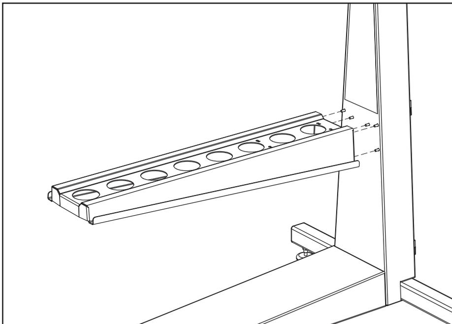
Mit sechs M8 x 20 mm-Schrauben (Punkt. # 7.3) montieren Sie den Träger (Punkt # 4) an die Säule (Punkt # 1). Hinweis: Alle Schrauben anfangs nur lose eindrehen und erst anziehen, nachdem alle montiert sind.
