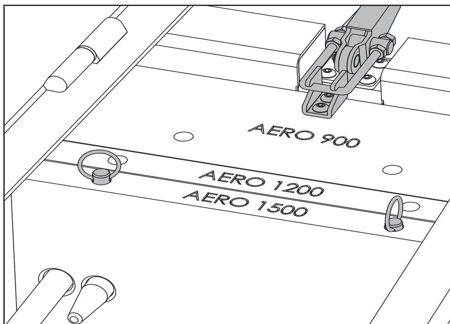
Wenn die Säule auf dem Boden liegt, öffnen Sie die Klappe und entfernen das Verpackungsmaterial. Setzen Sie die Stifte des Gewichtsmechanismus in die Position Aero 1500. Schieben Sie alle drei Gewichte nach oben und befestigen Sie sie mit dem Schnellspanner. Stellen Sie sicher, dass der Riegel die Gewichte sicher hält.
