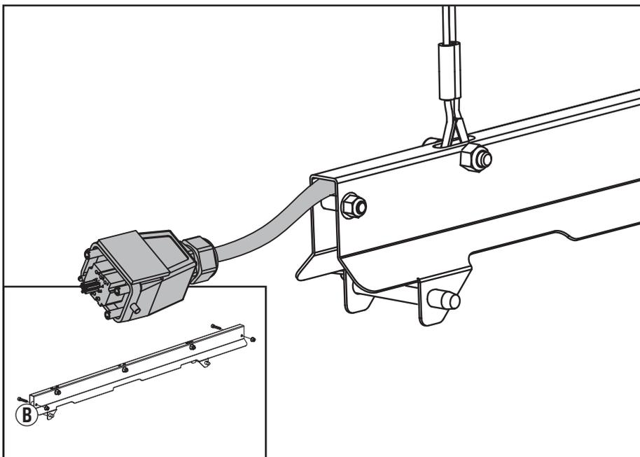
Beim Aero Stand 08114 mit zwei M6 × 30 mm-Schrauben (Punkt # 7.7), zwei M6-Muttern (Punkt # 7.9) und zwei 6 mm- Distanzstücken (Punkt # 7.10) die Verlängerung des Versorgungskabels (Punkt # 08319) in der Hebeschiene befestigen, wobei der Stecker ohne Verriegelung aus Ende B hervorsteht.
