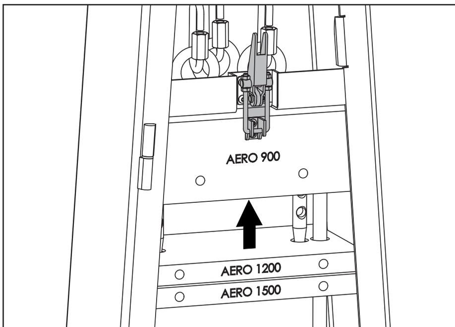
Heben Sie das Aero 900 Gewicht hoch und schließen Sie die Gewichtsverriegelung. Heben Sie die Gewichte für Aero 1200 und 1500 an und sichern Sie sie mit den Stiften in der obersten Position. Meiden Sie die Punkte, wo Sie sich die Finger einklemmen können!
