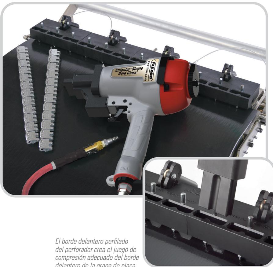
El borde delantero perfilado del perforador crea el juego de compresión adecuado del borde delantero de la grapa de placa.
