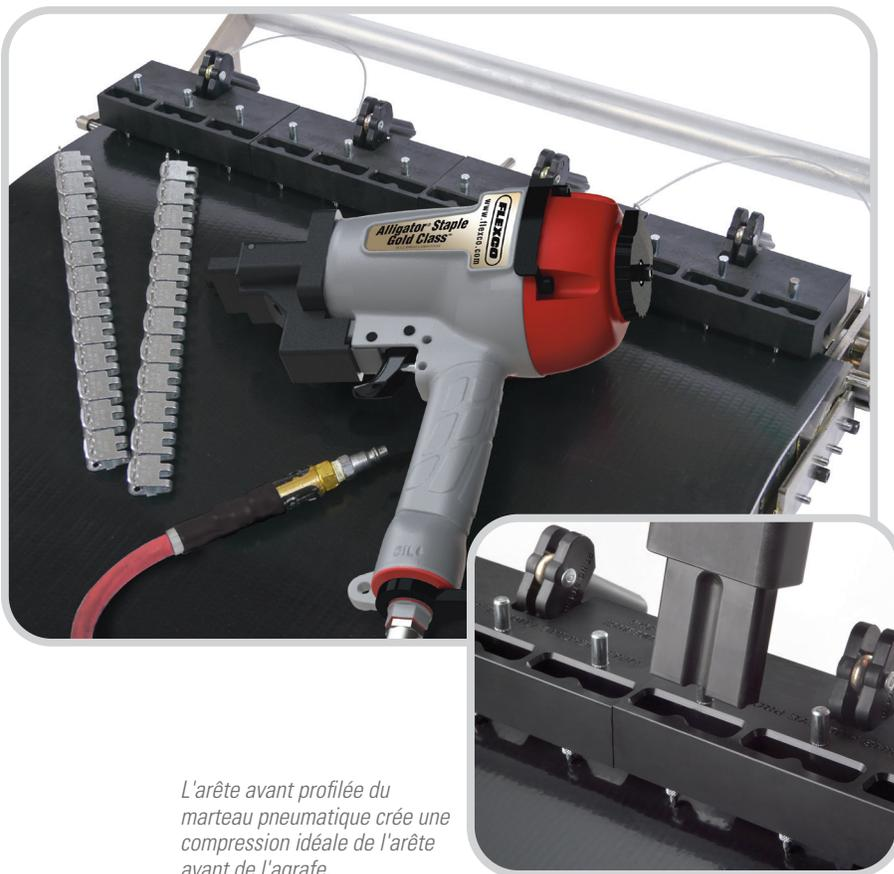
L'arête avant profilée du marteau pneumatique crée une compression idéale de l'arête avant de l'agrafe.
