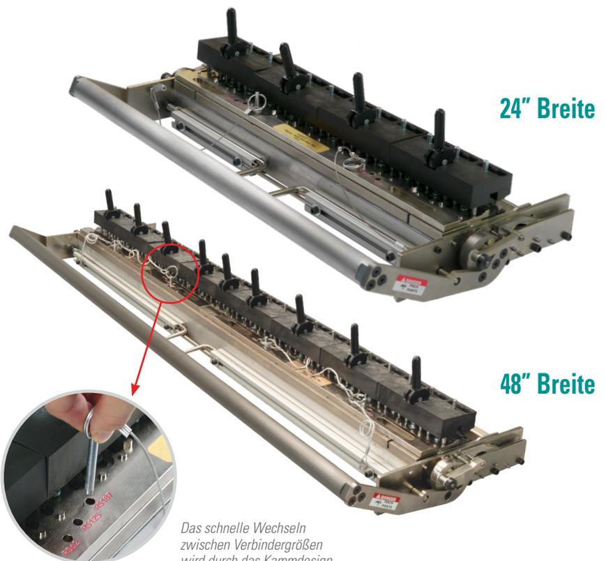
Das schnelle Wechseln zwischen Verbindergrößen wird durch das Kammdesign des Gold Class™ Plus erreicht.
